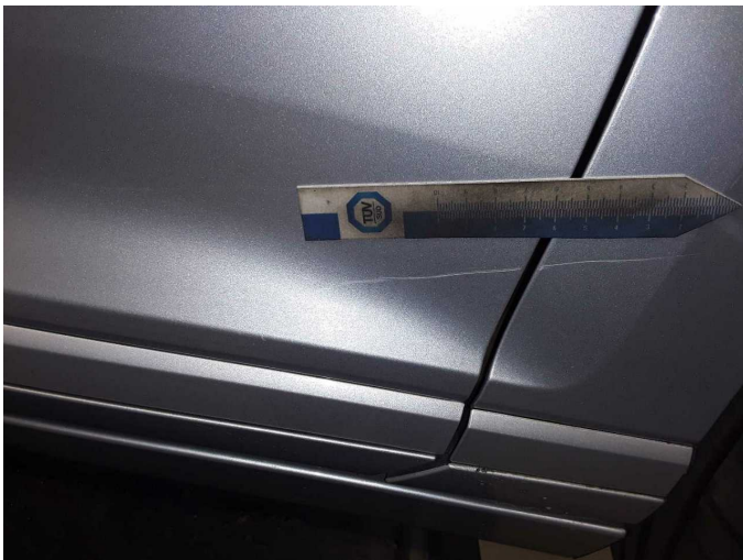
Damage 5: Door - front right side: Door (Unten) - Scratch(es) - Smart repair
