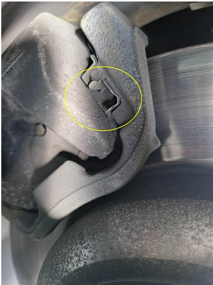
Bild 21 : Bremsbeläge an der Hinterachse an Verschleissgrenze
