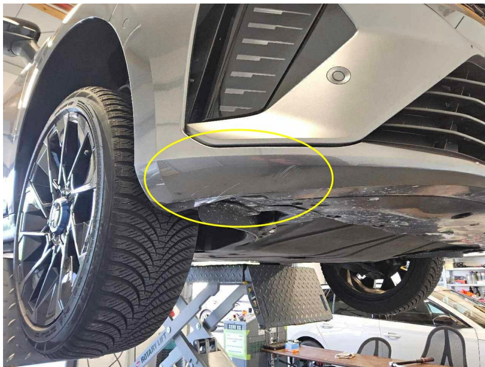
Bild 11 : Stoßfänger vorne rechts unterhalb verschrammt
