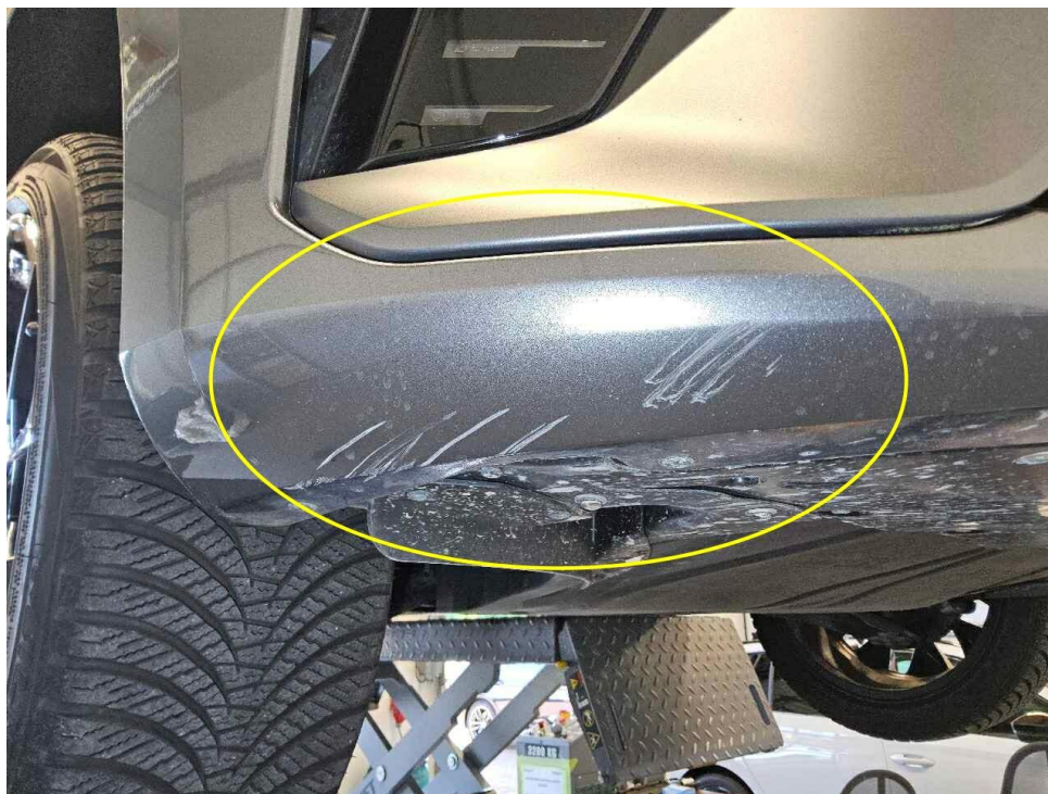
Bild 12 : Stoßfänger vorne rechts unterhalb verschrammt
