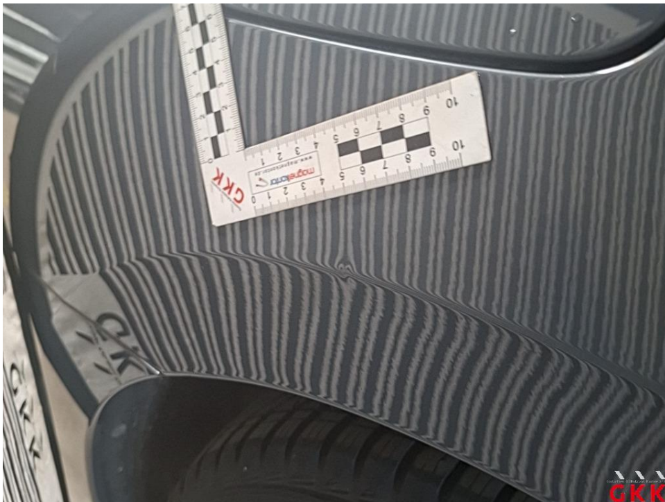
Bild 22 Seitenwand rechts, beschädigt, instand setzen - lackieren
