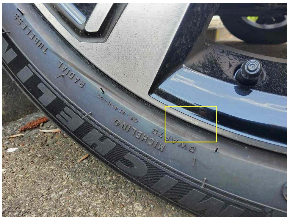
Bild 6 : Felge vorne links Kratzer
