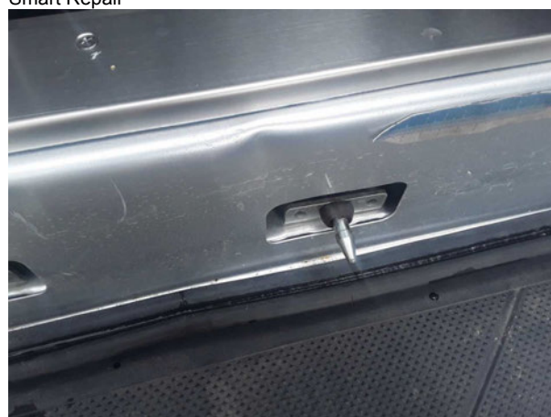
Beschädigung #5: Heckbereich: Heckblech - Delle / Lackschaden - Smart Repair
