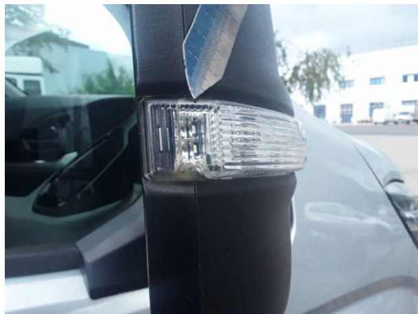
Beschädigung #1: Blinkleuchte: Spiegel rechts - gebrochen / gerissen - erneuern
