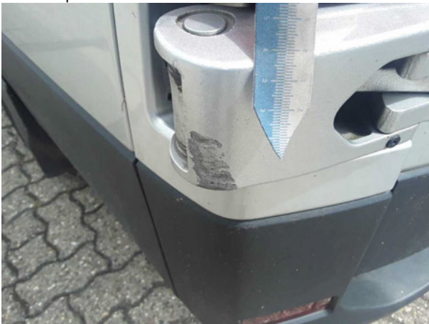
Beschädigung #6: Heckklappe/-tür: Scharnier unten - Kratzer - lackieren
