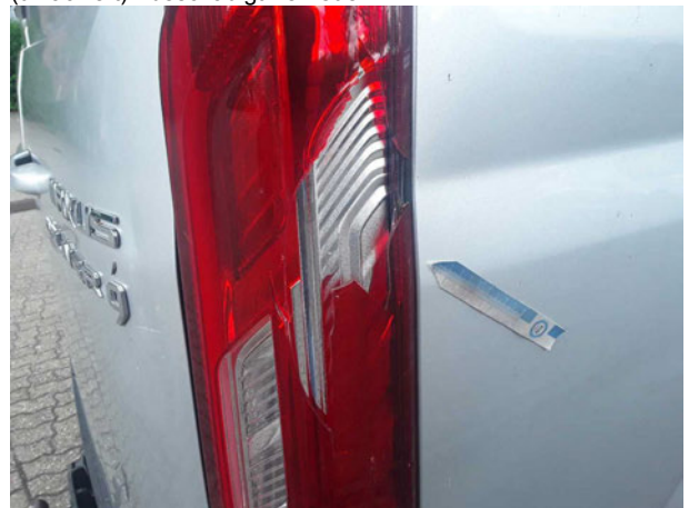
Beschädigung #8: Heckleuchte: Heckleuchte rechts - gebrochen / gerissen - erneuern
