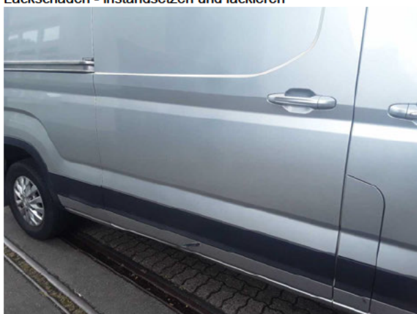
Beschädigung #14: Schiebetür rechts: Schiebetür - Delle / Lackschaden - instandsetzen und lackieren
