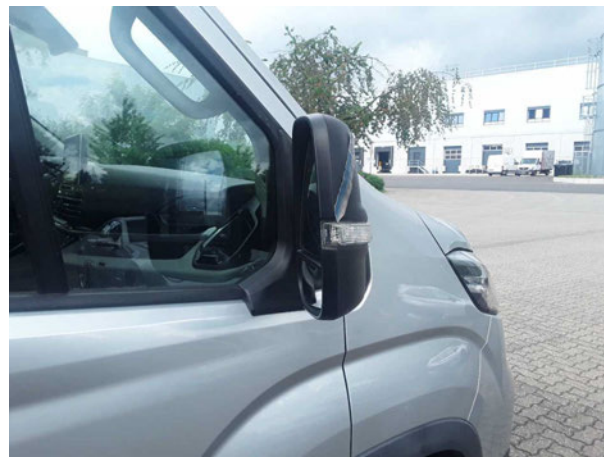
Beschädigung #1: Blinkleuchte: Spiegel rechts - gebrochen / gerissen - erneuern
