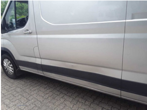
Beschädigung #15: Seitenwand links: Seitenwand - verformt - instandsetzen und lackieren
