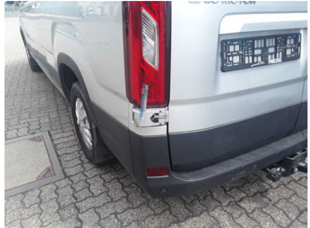
Beschädigung #6: Heckklappe/-tür: Scharnier unten - Kratzer - lackieren
