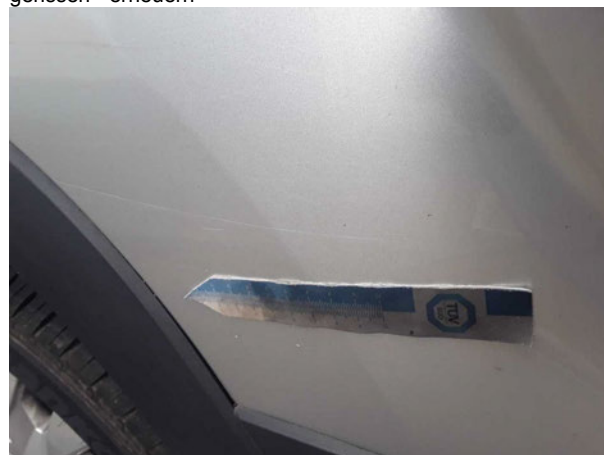
Beschädigung #2: Seitenwand rechts: Seitenwand - Kratzer - Smart Repair
