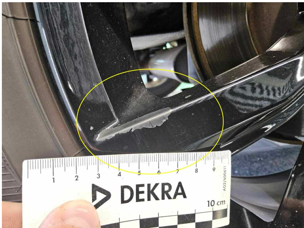
Bild 26 : Sommerfelge hinten rechts Lackablösung
