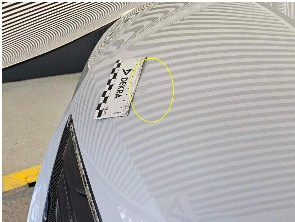
Bild 19 : Motorhaube großer Steinschlag Restausbesserungsspuren erkennbar
