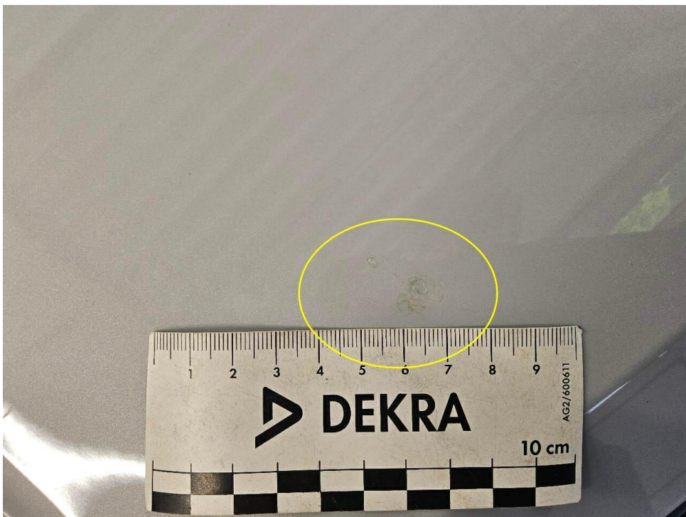
Bild 18 : Motorhaube großer Steinschlag Restausbesserungsspuren erkennbar
