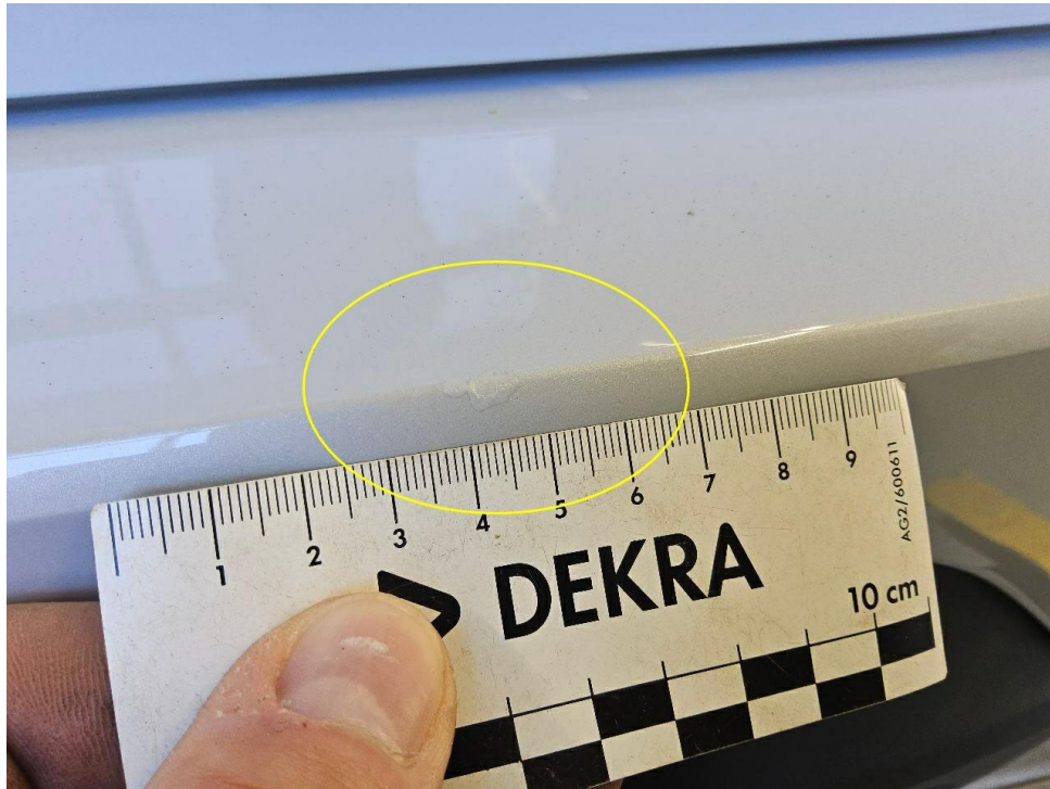
Bild 21 : Stoßfänger hinten Ladekante zerkratzt und ausgebessert
