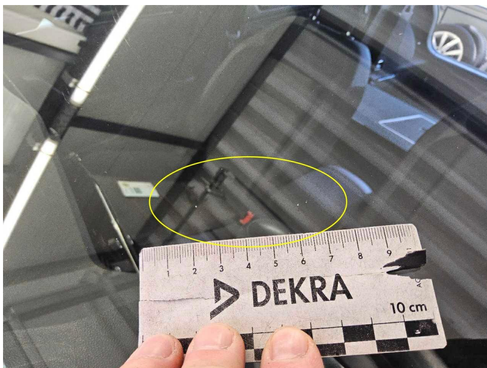
Bild 16 : Windschutzscheibe oberflächliche Steinschläge
