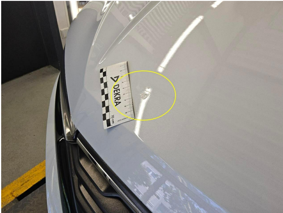
Bild 17 : Motorhaube großer Steinschlag Restausbesserungsspuren erkennbar
