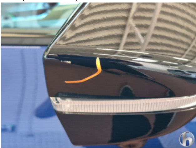
2. Außenspiegel Gehäuse - Rechts Abschürfung - Smart Repair
