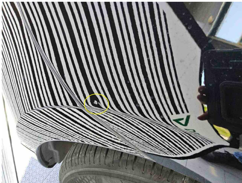
Bild 21 : Seitenteil hinten rechts, eingedellt, instandsetzen und lackieren mit Lackaufbau
