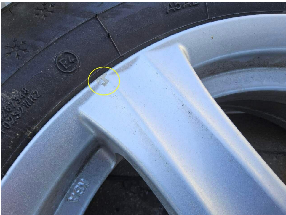
Bild 14 : Leichtmetallfelge Winterradsatz vorn rechts und hinten rechts verschrammt (Gebrauchsspur)
