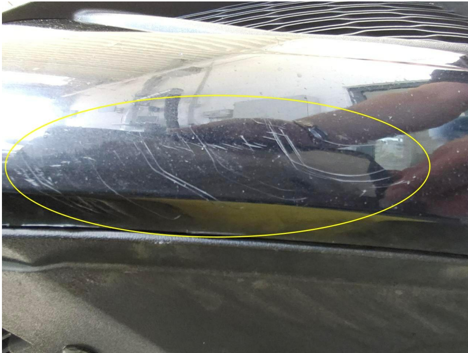
Bild 24 : Stossfänger vorn unterhalb links verkratzt
