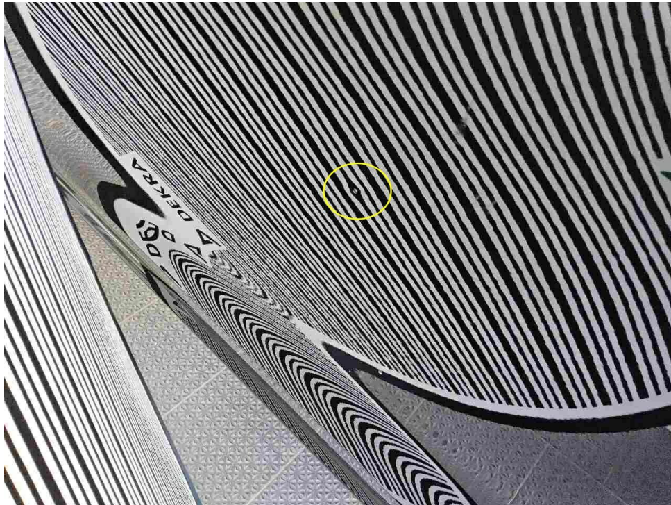
Bild 18 : Tür vorn links eingedellt (Gebrauchsspur)
