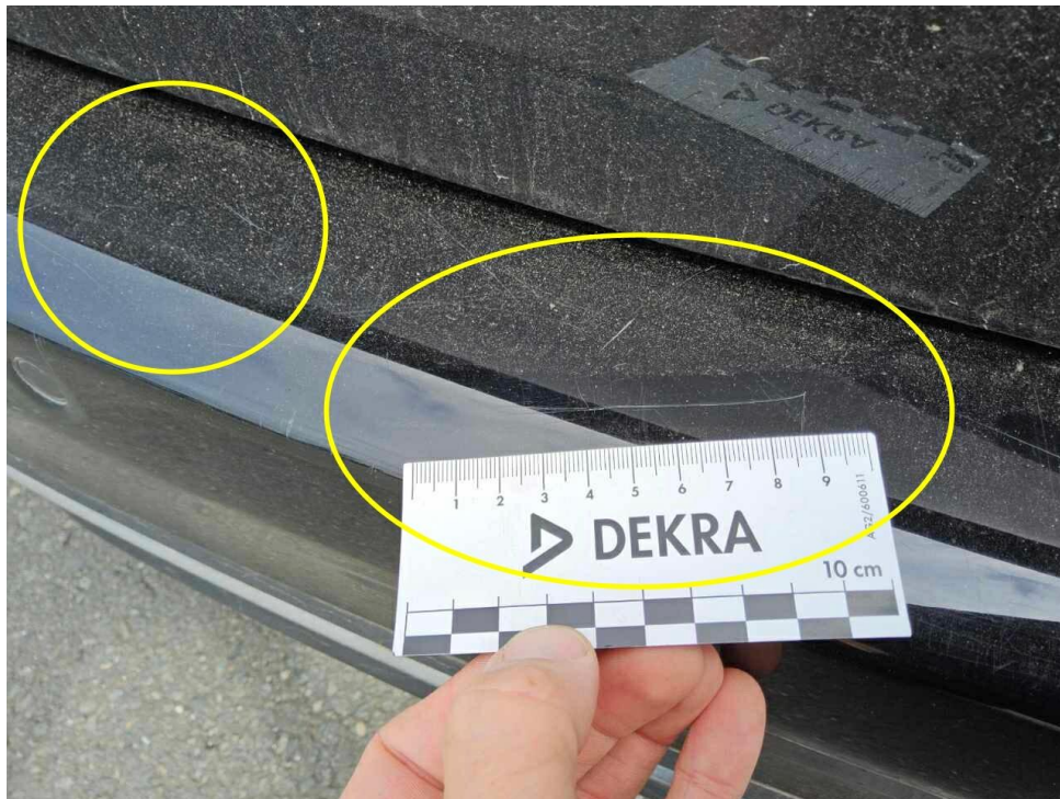
Bild 19 : Stoßfänger hinten, eingedellt, instandsetzen und lackieren mit Lackaufbau
