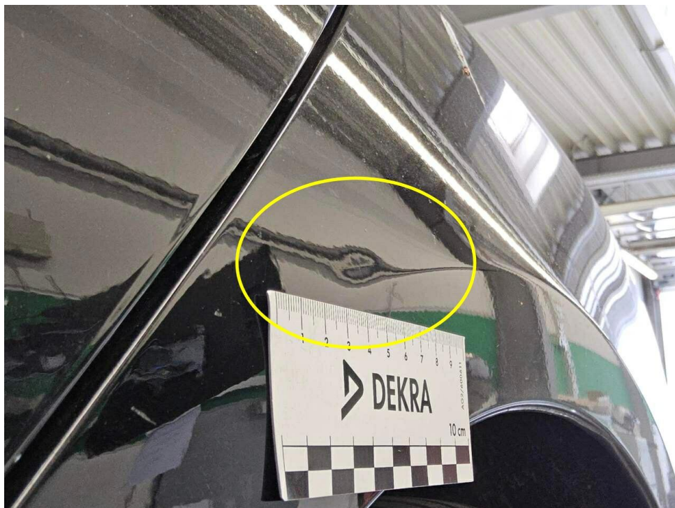
Bild 16 : Seitenteil hinten links, eingedellt, drücken
