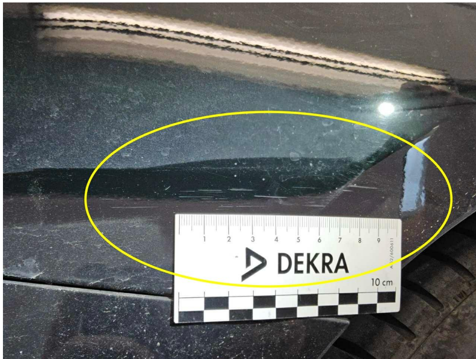
Bild 15 : Seitenteil hinten rechts, eingedellt, instandsetzen und lackieren mit Lackaufbau
