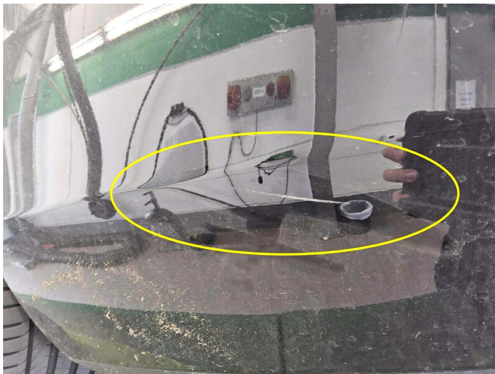
Bild 17 : Stoßfänger hinten, eingedellt, instandsetzen und lackieren mit Lackaufbau
