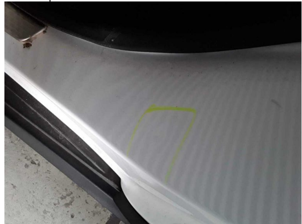
Beschädigung #9: Seitenwand links: Einstieg - Delle(n) - sanft instandsetzen
