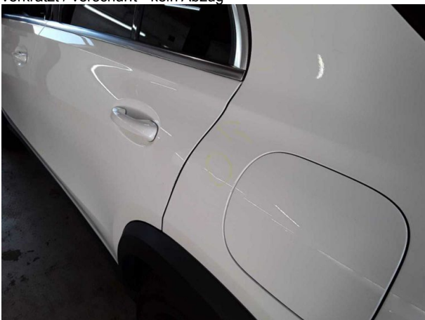
Beschädigung #4: Seitenwand links: Seitenwand - Delle(n) - sanft instandsetzen
