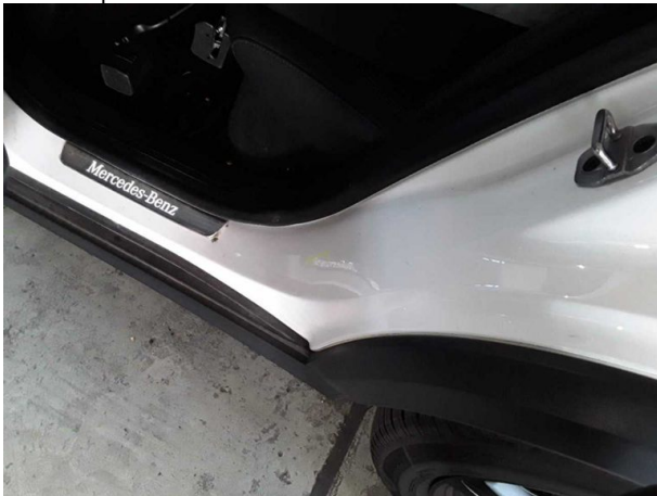
Beschädigung #9: Seitenwand links: Einstieg - Delle(n) - sanft instandsetzen
