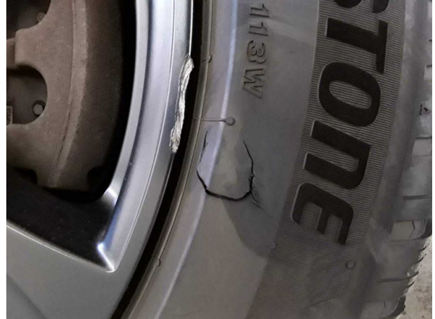
Beschädigung #2: Rad/Reifen: Reifen vorn links - beschädigt... kein Abzug
