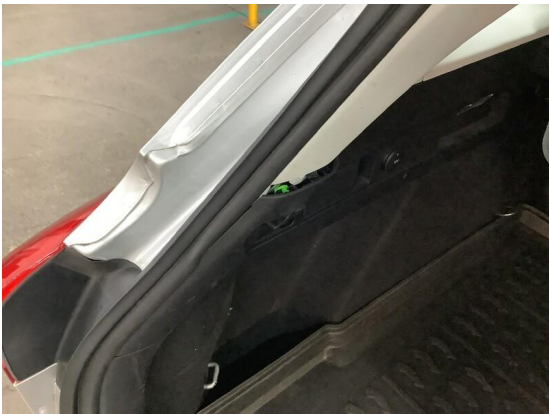
Bild 3: Innenraum / Kofferraumverkleidung links lose
