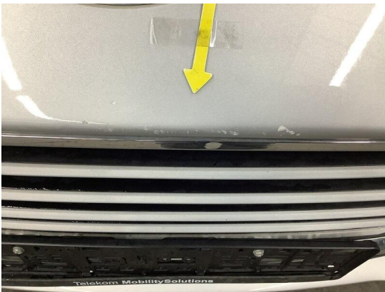
Bild 9: Karosserie / Stoßfänger vorne deformiert
