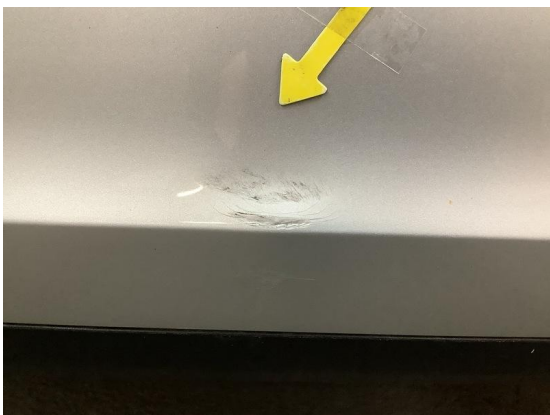
Bild 23: Karosserie / Stoßfänger hinten zerkratzt und deformiert
