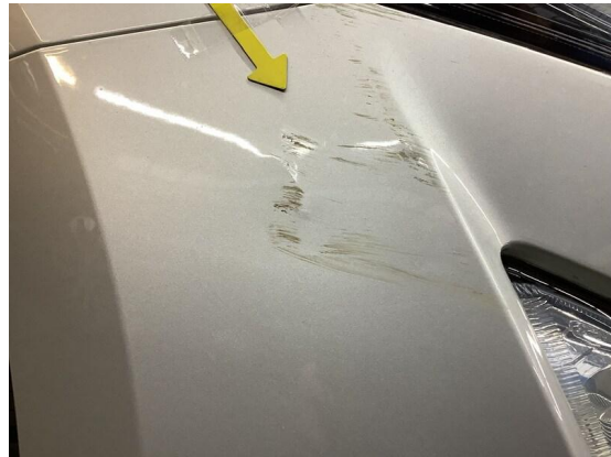
Bild 8: Karosserie / Stoßfänger vorne deformiert
