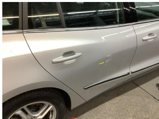
Bild 16: Karosserie / Tür hinten rechts deformiert
