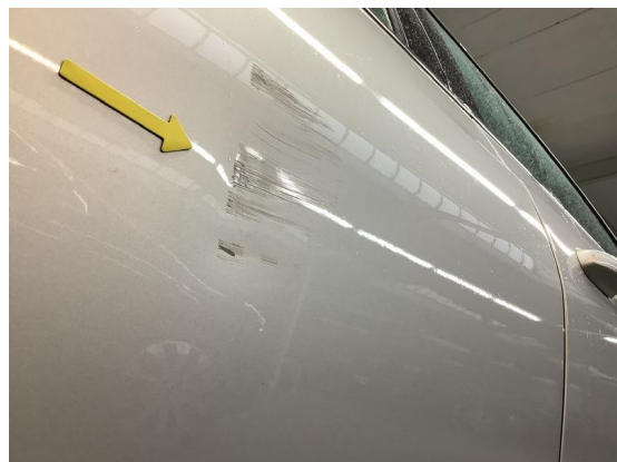
Bild 18: Karosserie / Tür hinten rechts deformiert
