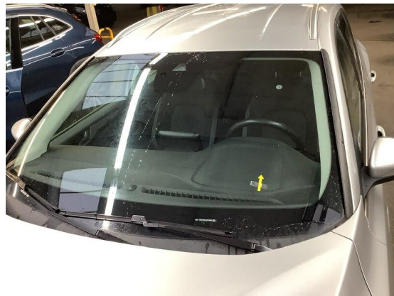
Bild 10: Karosserie / Windschutzscheibe Steinschlag im Fahrersichtfeld
