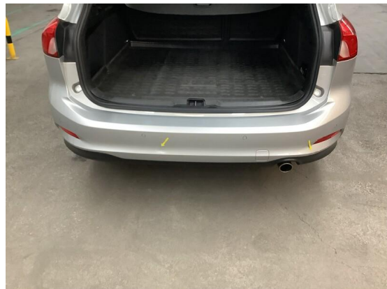
Bild 22: Karosserie / Stoßfänger hinten zerkratzt und deformiert
