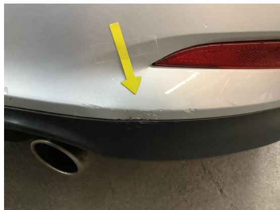
Bild 24: Karosserie / Stoßfänger hinten zerkratzt und deformiert
