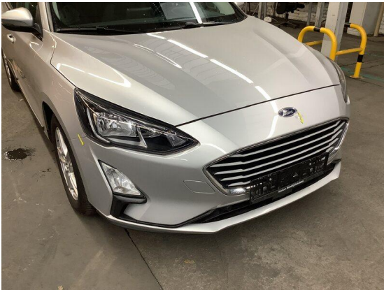
Bild 7: Karosserie / Stoßfänger vorne deformiert
