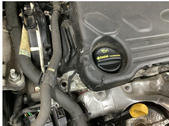
Bild 4: Technik / Motor Motorabdeckung oben beschädigt
