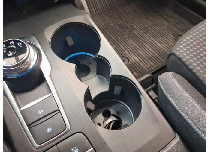
Damage 10: Instrument panel: Centre console - front (Getränkhalter, Fehlbohrungen) - Differs from the original configuration - Replace
