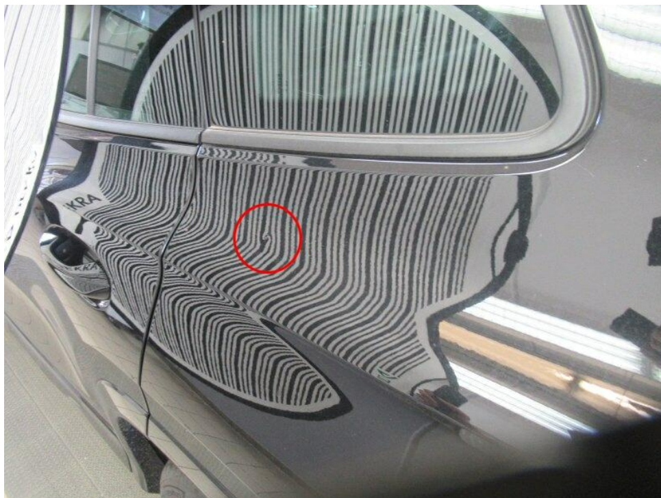
Bild 18 : Seitenteil hinten links, eingedellt, drücken
