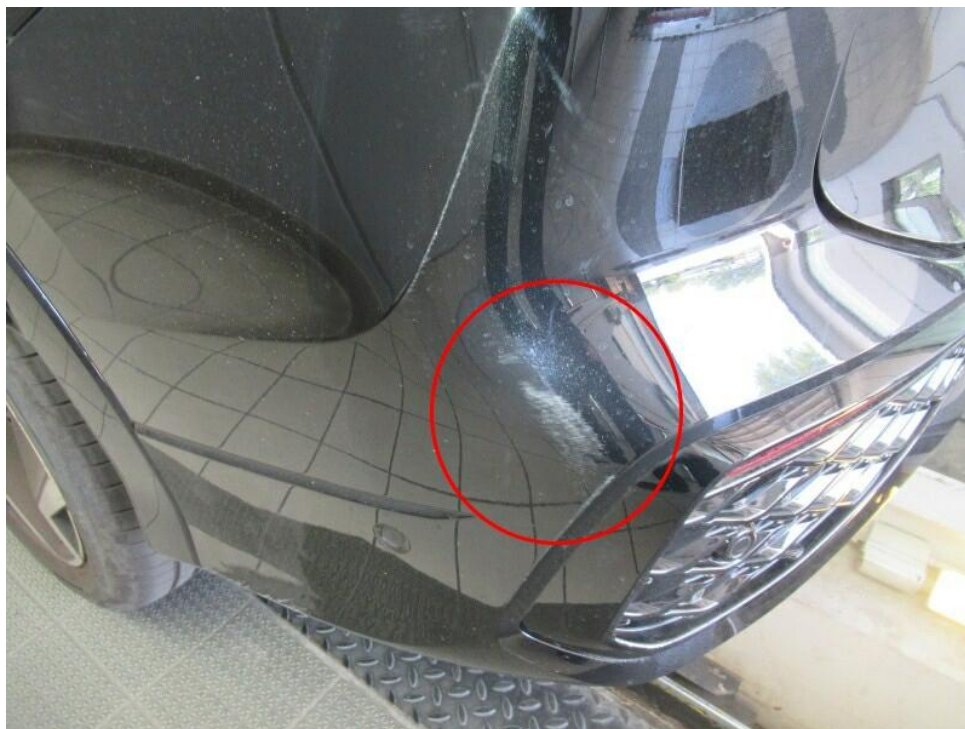
Bild 17 : Stoßfänger hinten Lackierung, zerkratzt, polieren
