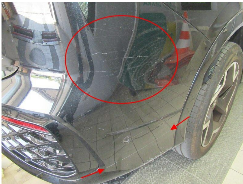
Bild 16 : Stoßfänger hinten Lackierung, zerkratzt, polieren
