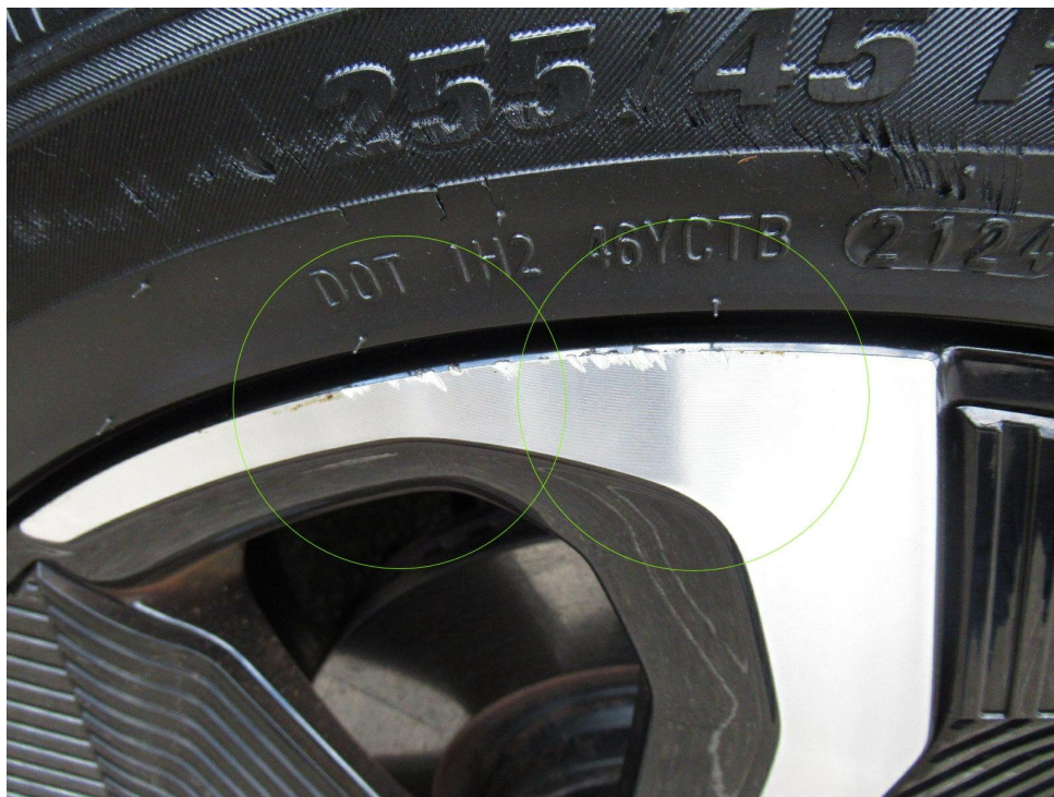
Bild 8 : Felge vorn rechts beschädigt Glanzgedreht
