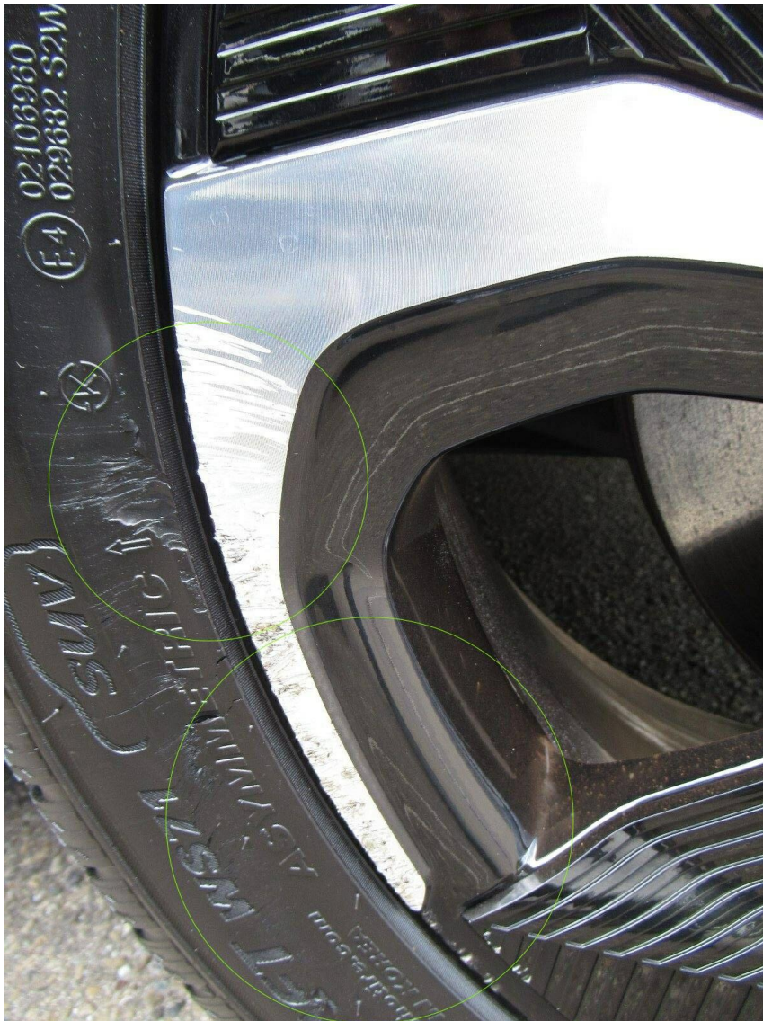
Bild 9 : Felge vorn rechts beschädigt Glanzgedreht
