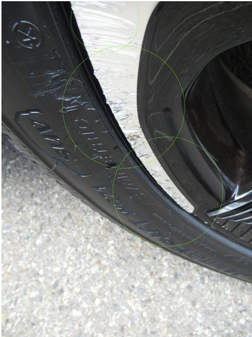
Bild 10 : Felge vorn rechts beschädigt Glanzgedreht
