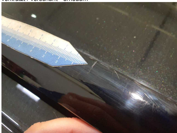
Beschädigung #3: Fahrzeugdach: Dachreling links - verkratzt / verschürft - lackieren
