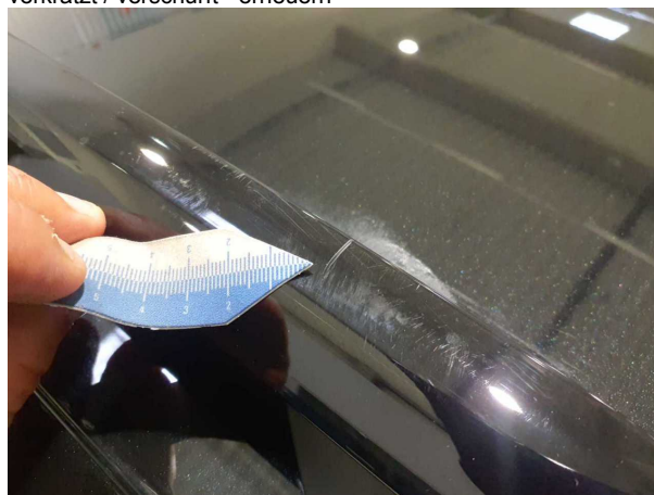
Beschädigung #3: Fahrzeugdach: Dachreling links - verkratzt / verschürft - lackieren
