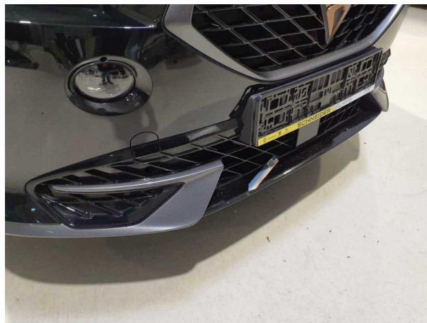
Beschädigung #2: Stossfänger vorn: Spoiler (Druckstelle) - verkratzt / verschürft - erneuern
