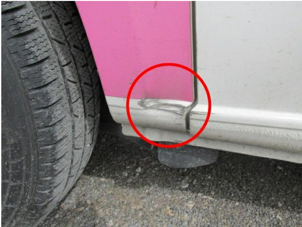
Bild 25 : Seitenwand hinten rechts unterhalb deformiert
