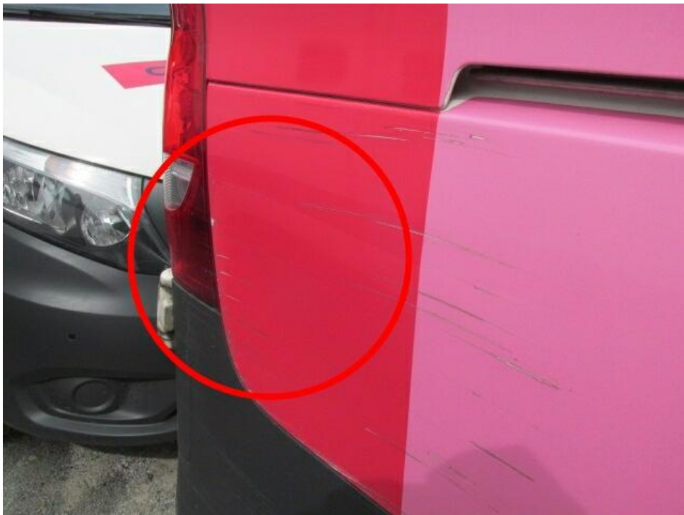
Bild 24 : Seitenwand hinten rechts unterhalb deformiert
