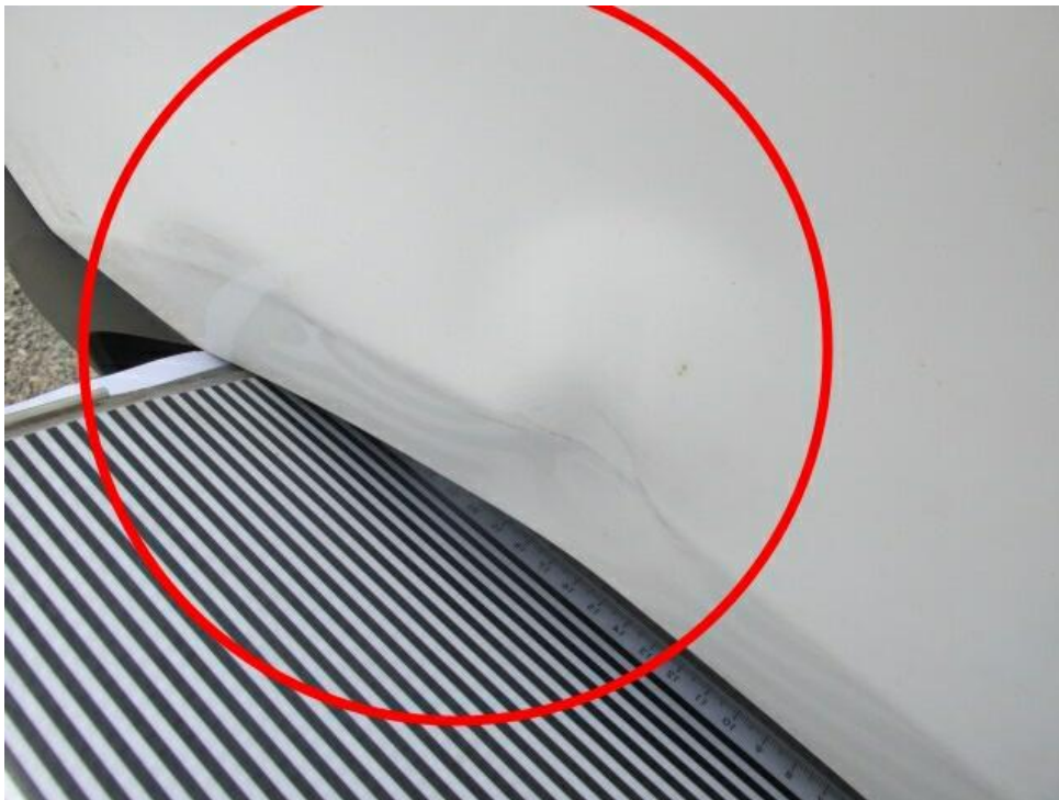
Bild 20 : Kotflügel vorne links deformiert, Stoßfänger vorne linksseitig verformt
