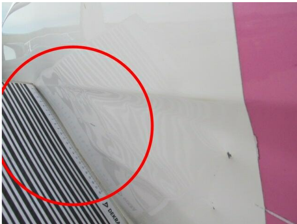
Bild 16 : Seitenwand hinten links deformiert
