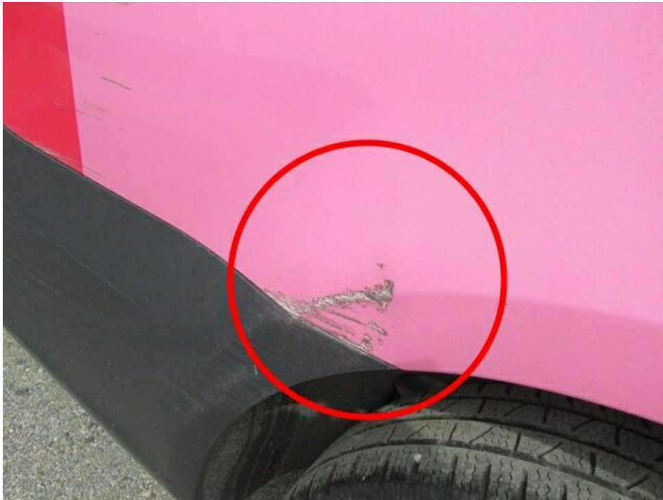
Bild 23 : Seitenwand hinten rechts unterhalb deformiert
