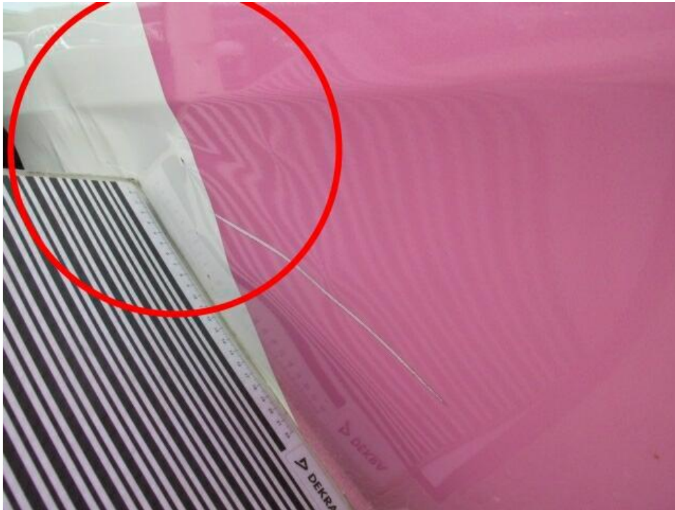
Bild 17 : Seitenwand hinten links deformiert
