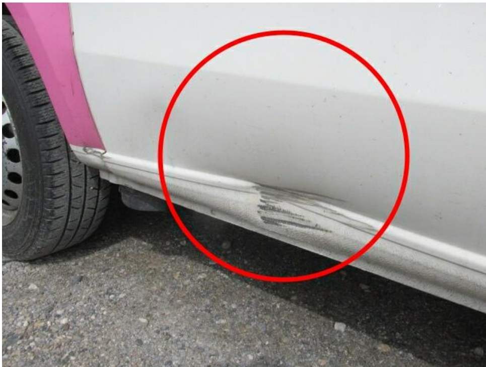
Bild 22 : Schiebetüre rechts deformiert
