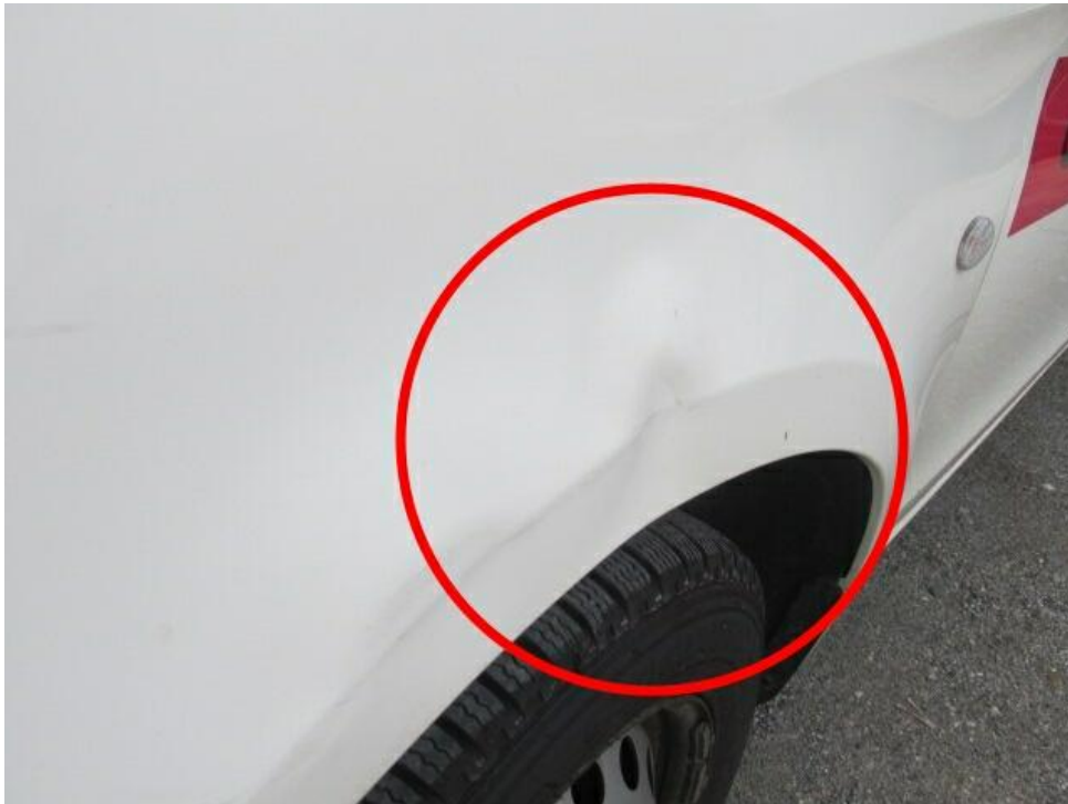
Bild 19 : Kotflügel vorne links deformiert, Stoßfänger vorne linksseitig verformt
