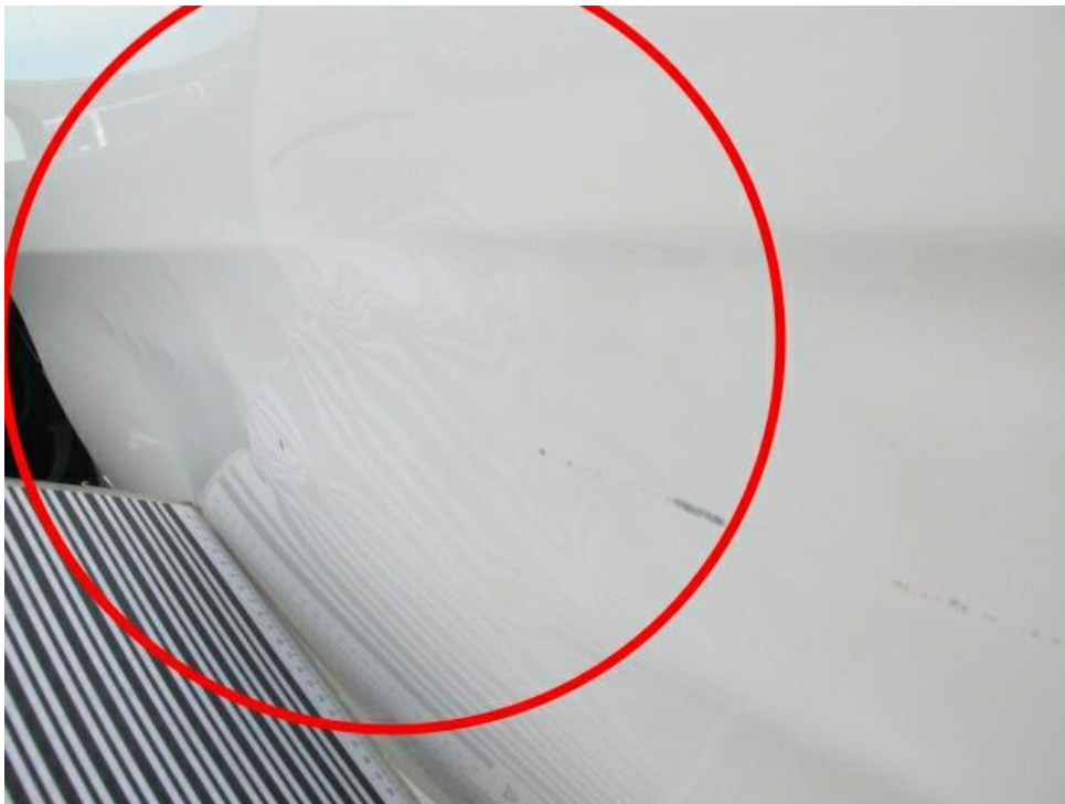
Bild 18 : Seitenwand hinten links deformiert
