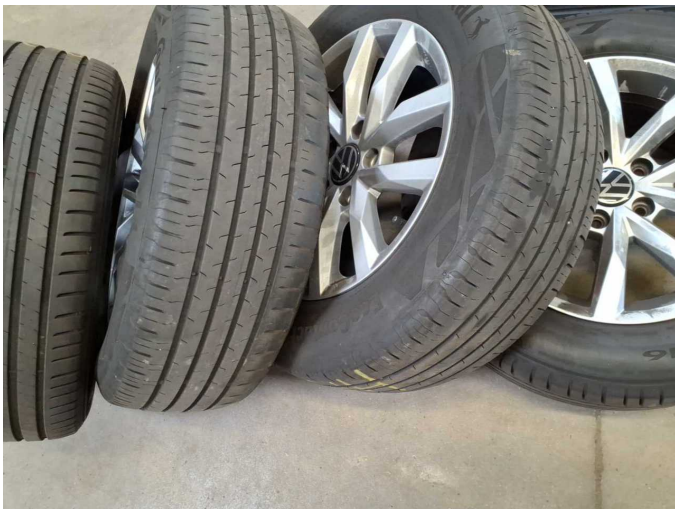
Damage 3: Wheel / tyres: Tyre - right (einseitig abgefahren) - Does not meet the leasing specifications - Replace
