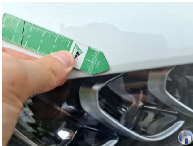
3. Stoßfänger Vorne Gebrauchsspuren - Ohne Reparatur
