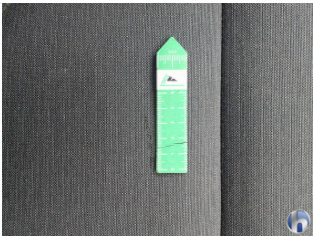
7. Sitz Innenraum rechts vorne Riss - Erneuern
