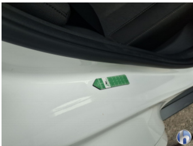
6. Türeinstieg Hinten - Rechts Delle - Sanft Instandsetzen
