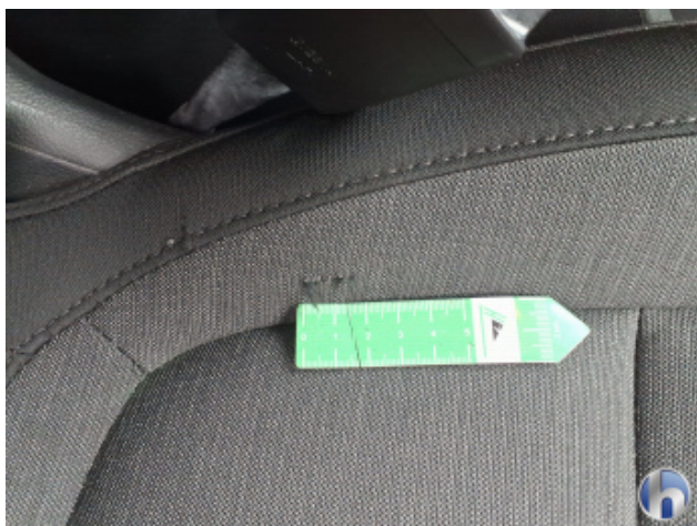
7. Sitz Innenraum rechts vorne Riss - Erneuern
