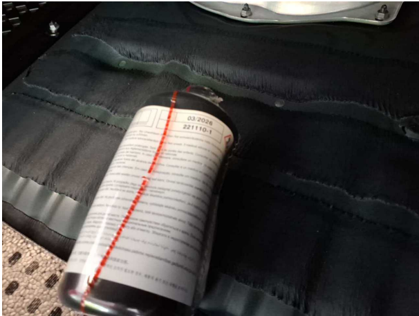
Beschädigung #1: Ausrüstung: Tirefit Füllmittel (03.2026) - abgelaufen - erneuern
