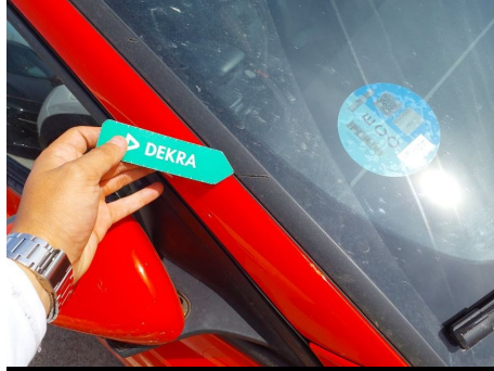
Goma de sellado del parabrisas / Delantero Derecho / Roto
