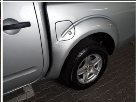
Kotflügel / Hinten Links / Rost
