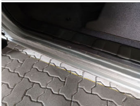
Türeinstieg / Vorne Links / Abgewetzt
