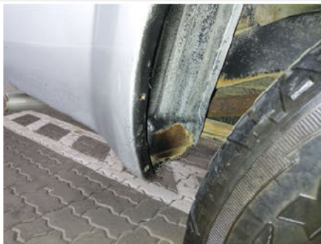
Kotflügel / Hinten Rechts / Rost
