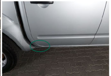
Schweller / Rechts / Rost
