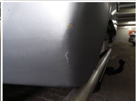
Kotflügel / Hinten Links / Rost
