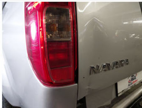
Heckleuchte / Hinten Links / Riss
