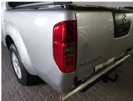
Heckleuchte / Hinten Links / Riss
