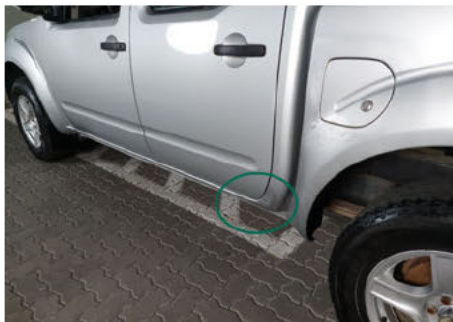
Schweller / Links / Rost
