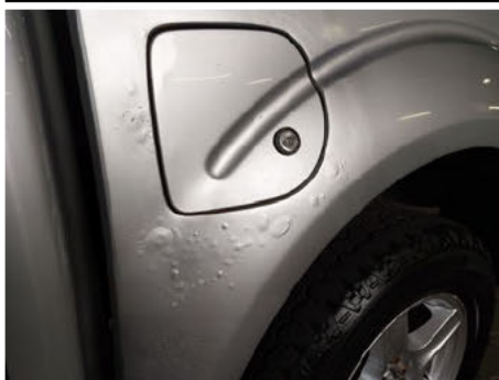
Kotflügel / Hinten Links / Rost
