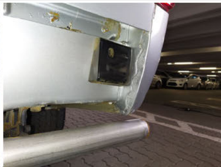
Kotflügel / Hinten Rechts / Rost
