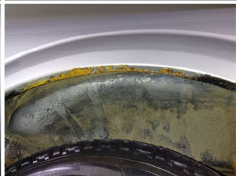
Kotflügel / Hinten Rechts / Rost
