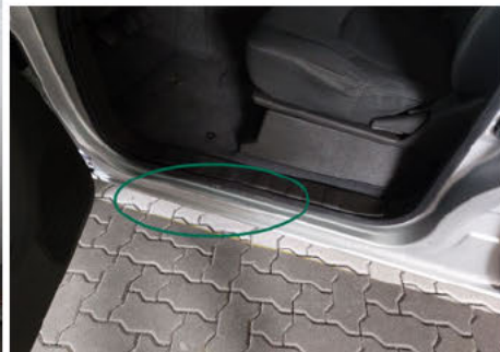
Türeinstieg / Vorne Links / Abgewetzt
