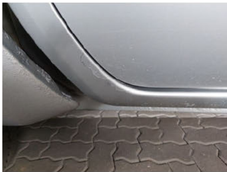
Schweller / Rechts / Rost
