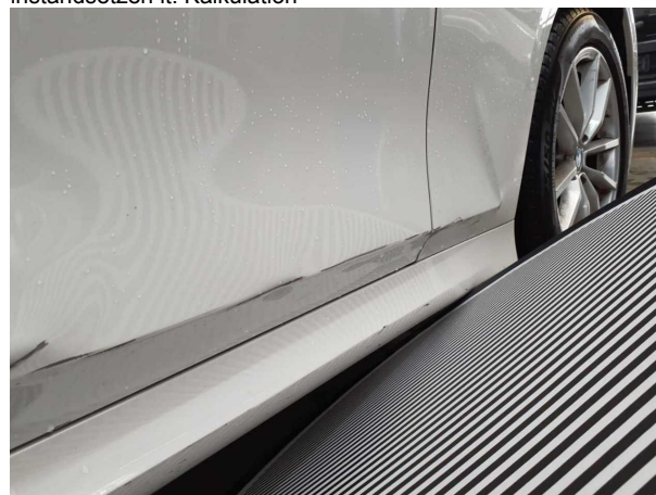
Beschädigung #3: Karosserie: Karosserie - beschädigt - instandsetzen lt. Kalkulation
