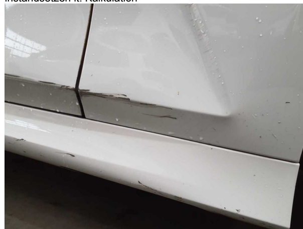
Beschädigung #3: Karosserie: Karosserie - beschädigt - instandsetzen lt. Kalkulation
