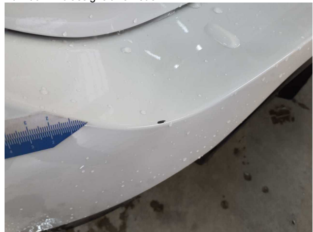
Beschädigung #2: Stossfänger hinten: Stossfänger hinten (Teillackierung) - Kratzer - Smart Repair
