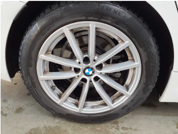
Beschädigung #1: Rad/Reifen: Reifen hinten rechts - Funktion / Zulässigkeit - erneuern
