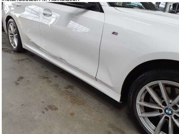
Beschädigung #3: Karosserie: Karosserie - beschädigt - instandsetzen lt. Kalkulation
