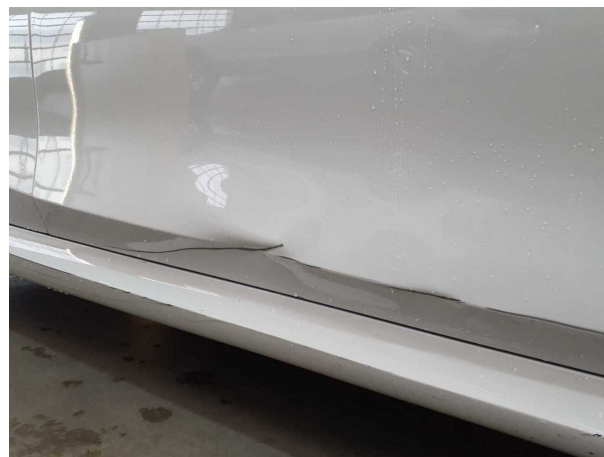
Beschädigung #3: Karosserie: Karosserie - beschädigt - instandsetzen lt. Kalkulation
