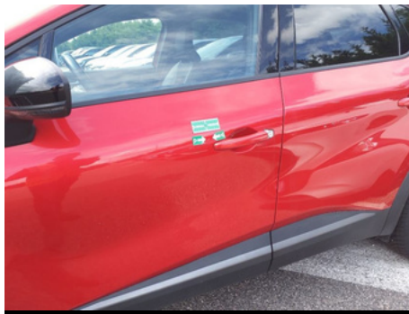
Porte / Avant Gauche / Enfoncement
