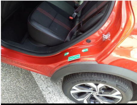
Entrée de porte / Arrière Gauche / Enfoncement
