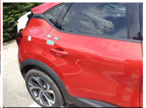
Porte / Arrière Droit / Enfoncement
