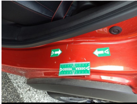
Entrée de porte / Arrière Gauche / Enfoncement
