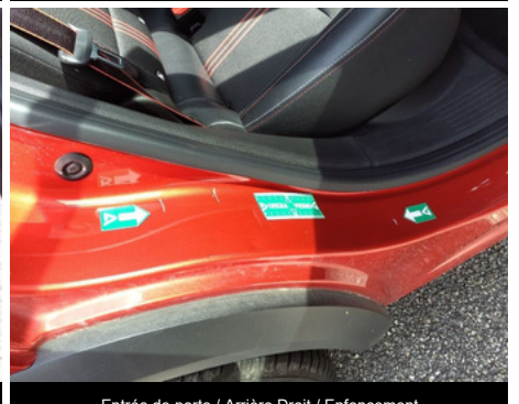
Entrée de porte / Arrière Droit / Enfoncement
