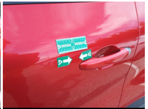
Porte / Avant Gauche / Enfoncement
