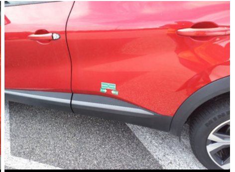
Porte / Arrière Gauche / Enfoncement
