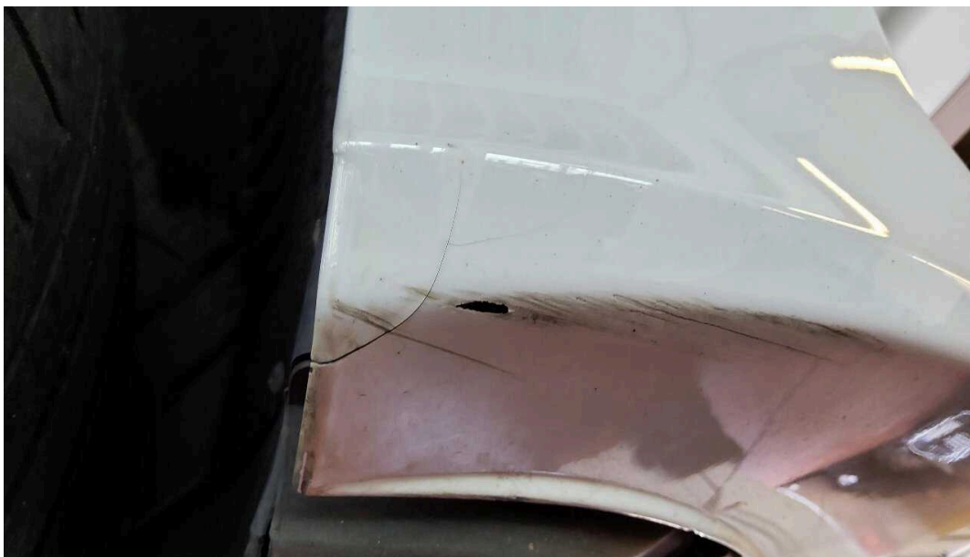
Bild 22 Fahrzeugfront Stoßfänger vorne Halterungen gebrochen - zusätzlich unsachgemäße Rep.links gebrochen
