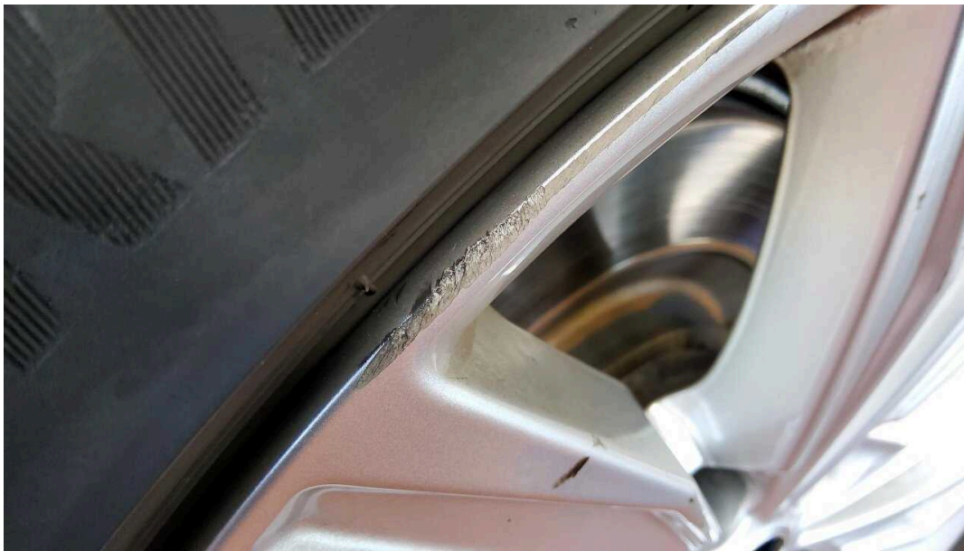
Bild 27 Hinterachse Felge hinten rechts mehrfach Materialabtrag
