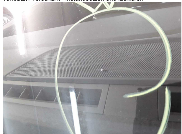
Beschädigung #7: Verglasung: Frontscheibe (Rissbildung) - Steinschlag - erneuern
