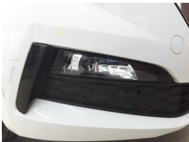
Beschädigung #2: Nebelleuchte: Nebelleuchte vorn rechts - verkratzt / verschürft - erneuern
