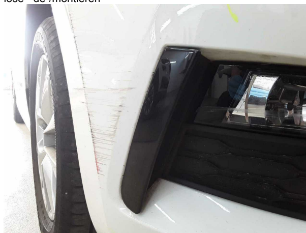
Beschädigung #5: Stossfänger vorn: Spoiler - beschädigt - erneuern
