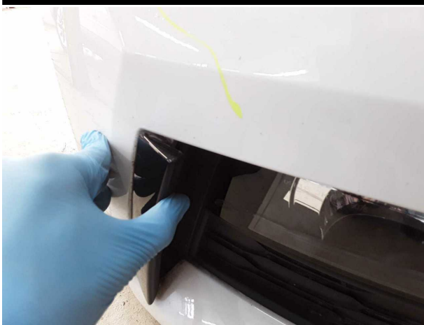
Beschädigung #5: Stossfänger vorn: Spoiler - beschädigt - erneuern
