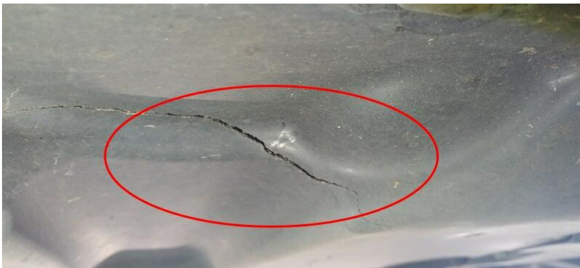
Bild 18 : Unterbodenabdeckung rechts gebrochen
