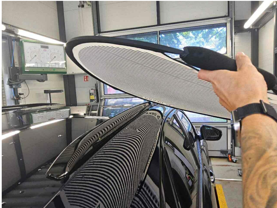
Bild 15 : Hagelschaden, Dachholm rechts
