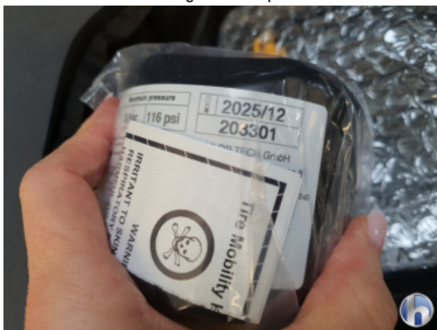
5. Tire-fit Füllmittel Fällig - Erneuern
