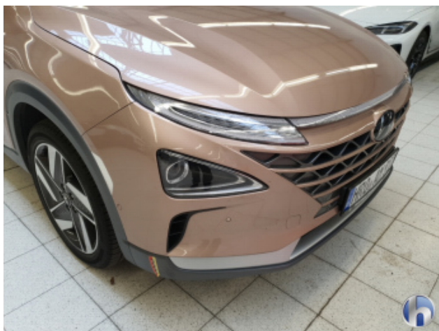
3. Frontspoiler Abschürfung - Smart Repair
