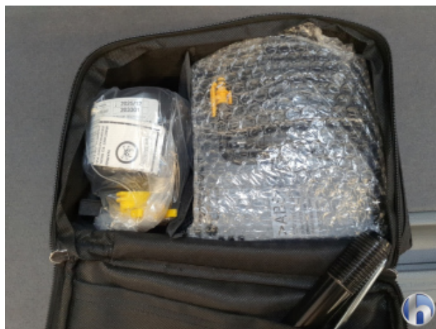
5. Tire-fit Füllmittel Fällig - Erneuern
