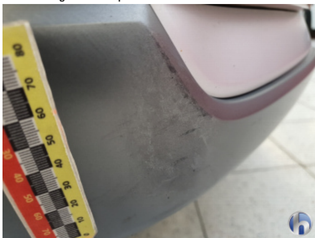
3. Frontspoiler Abschürfung - Smart Repair
