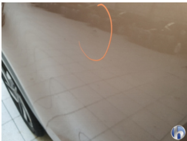
4. Tür Hinten - Rechts Kratzer Tief Bis Grundierung - Smart Repair
