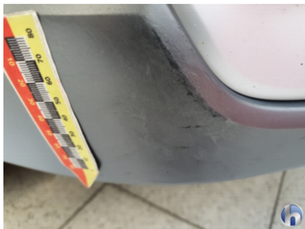
3. Frontspoiler Abschürfung - Smart Repair
