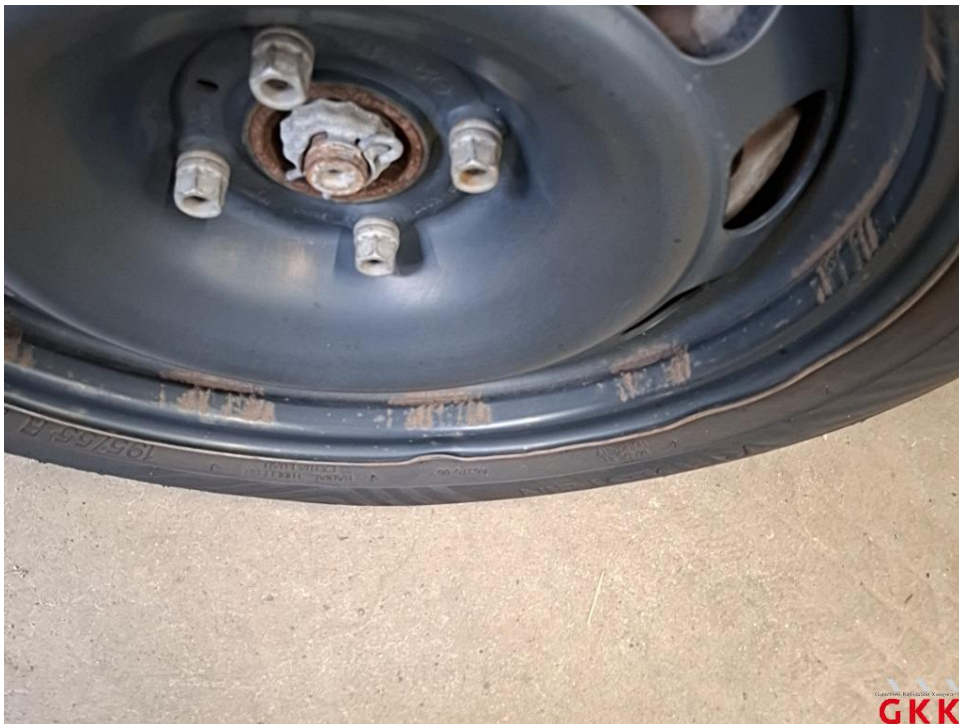
Bild 18 Stahlrad, vorne rechts, beschädigt, ersetzen
