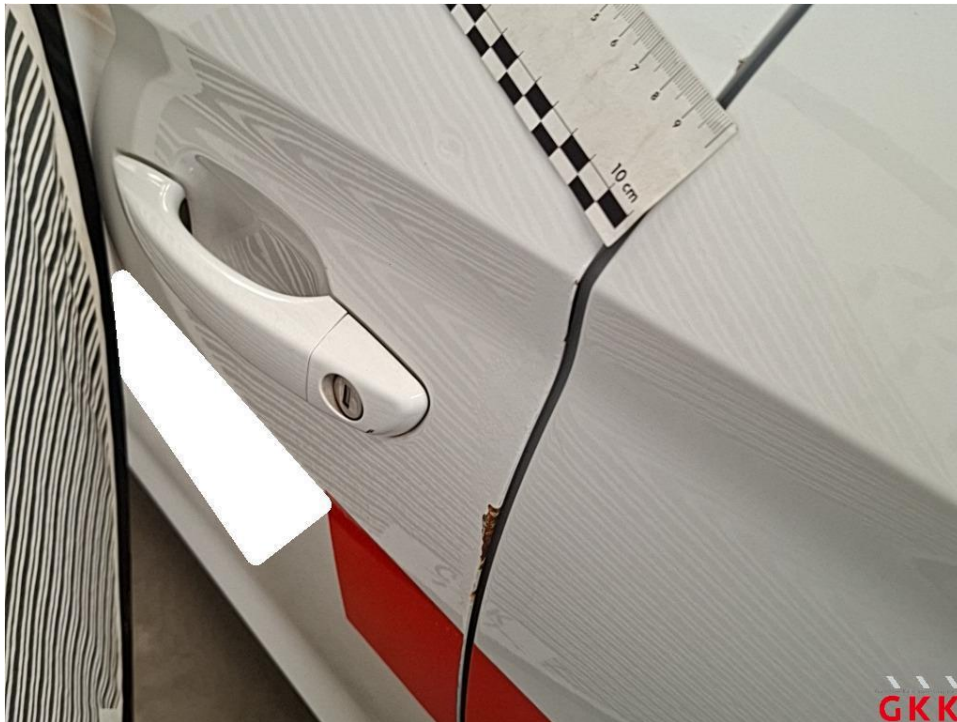
Bild 35 Tür vorne links, Reparaturmangel, instand setzen - lackieren
