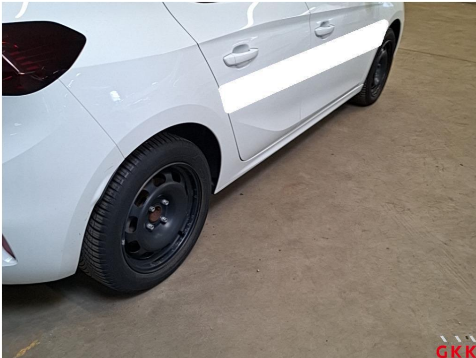
Bild 16 Radkappe(n), Satz, fehlt, ersetzen
