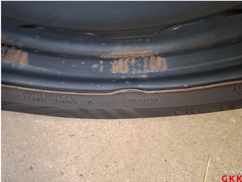
Bild 19 Stahlrad, vorne rechts, beschädigt, ersetzen
