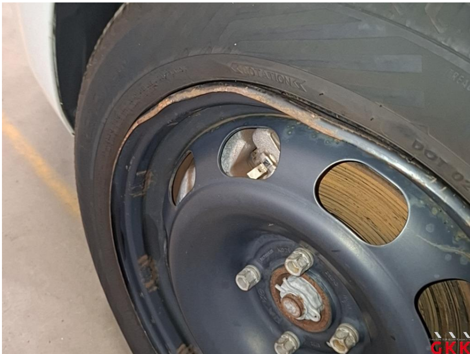
Bild 20 Stahlrad, vorne links, beschädigt, ersetzen
