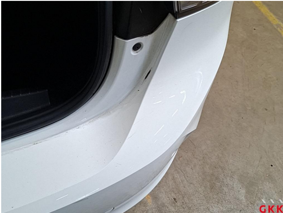
Bild 27 Stoßfänger hinten, Verkleidung -lackiert-, verkratzt, lackieren
