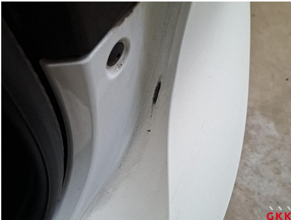
Bild 28 Stoßfänger hinten, Verkleidung -lackiert-, verkratzt, lackieren
