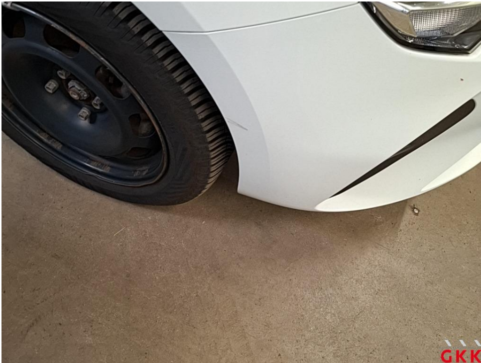
Bild 31 Stoßfänger vorne, Verkleidung -lackiert-, verkratzt, lackieren
