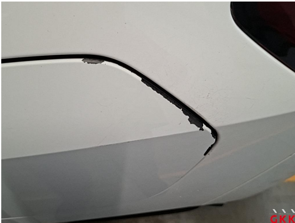
Bild 26 Tankdeckel, beschädigt, lackieren
