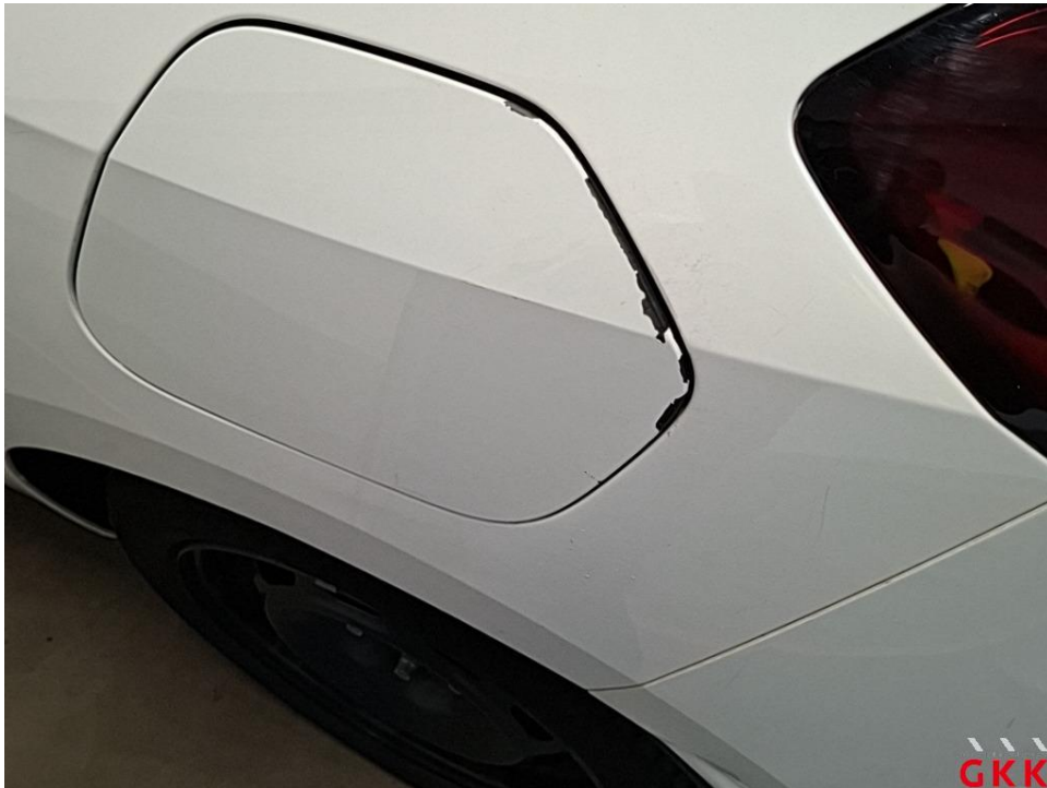
Bild 25 Tankdeckel, beschädigt, lackieren
