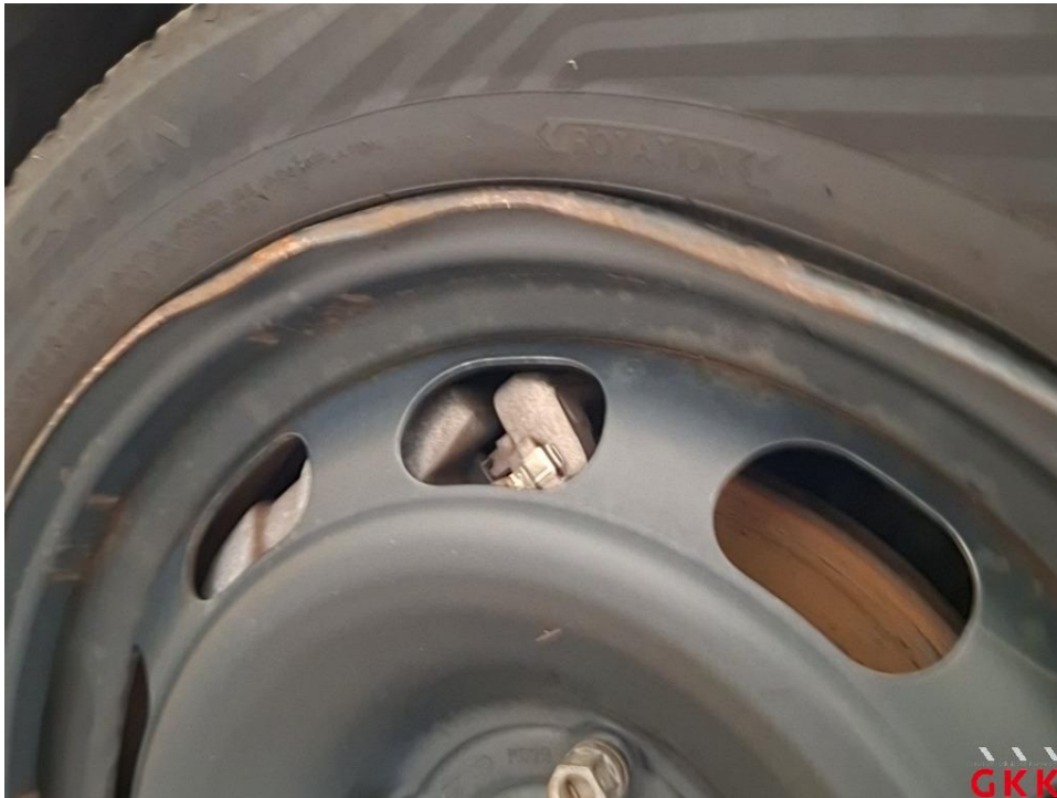
Bild 21 Stahlrad, vorne links, beschädigt, ersetzen
