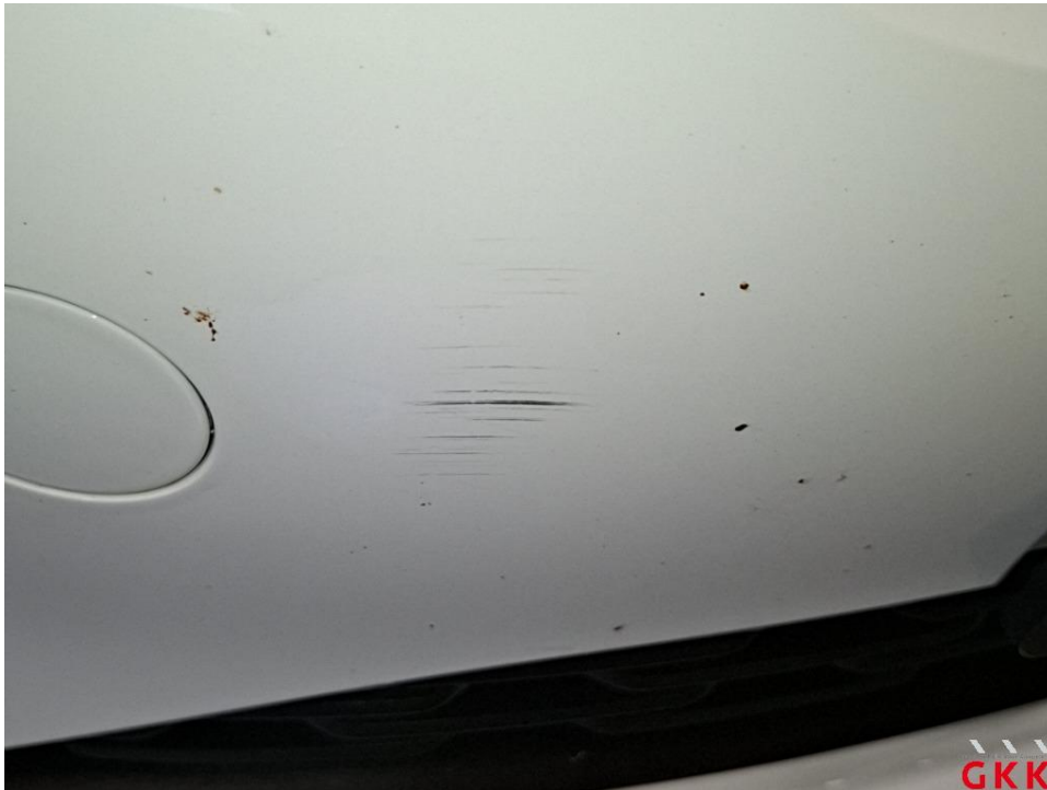
Bild 33 Stoßfänger vorne, Verkleidung -lackiert-, verkratzt, lackieren
