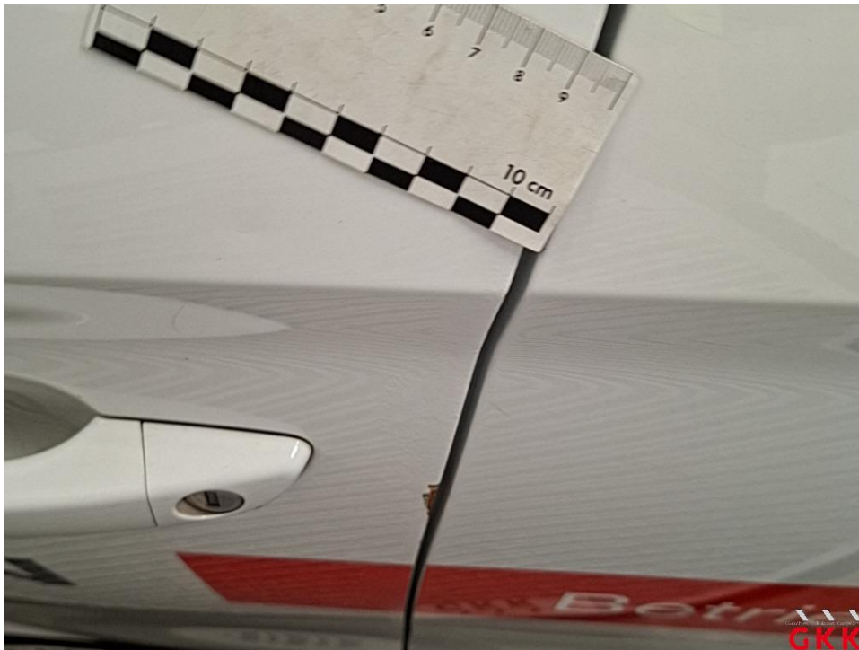
Bild 36 Tür vorne links, Reparaturmangel, instand setzen - lackieren
