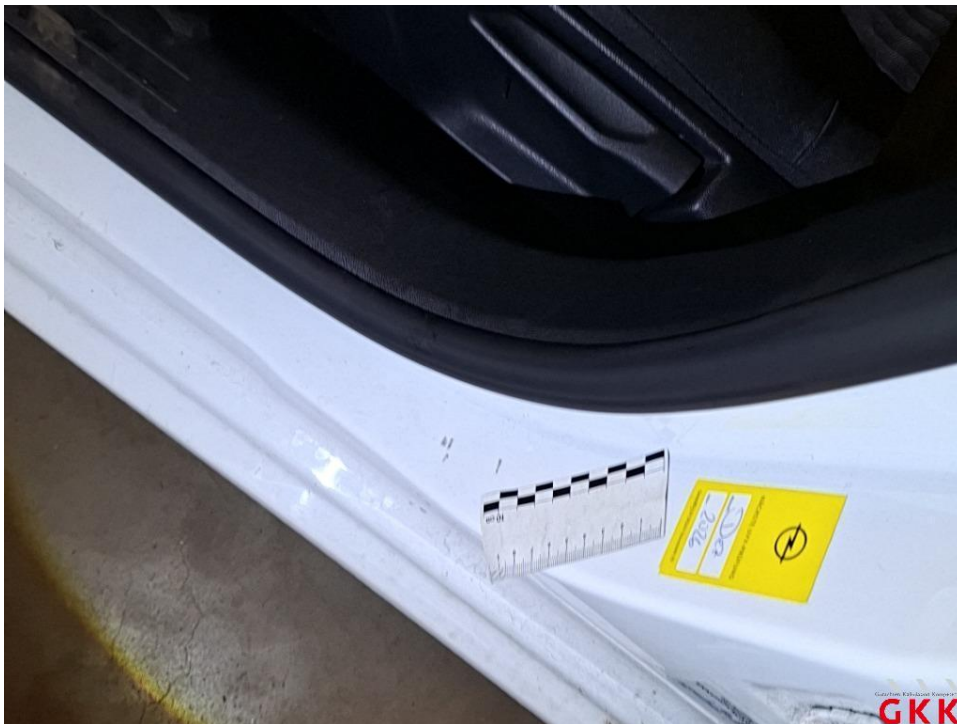
Bild 38 Tür vorne links, Einstieg, beschädigt, instand setzen - lackieren
