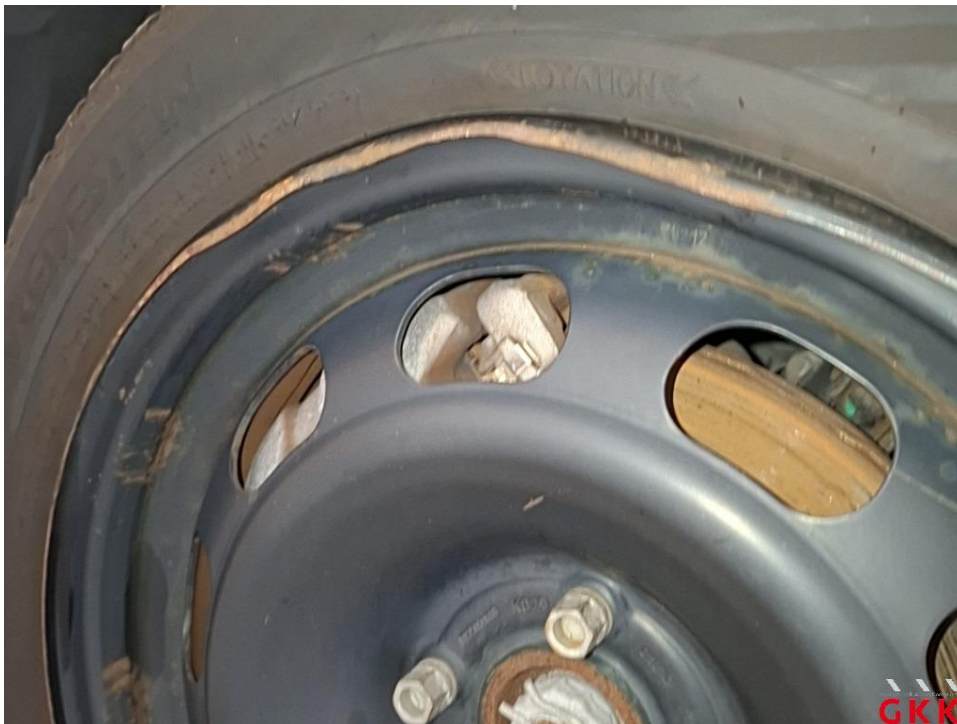
Bild 22 Stahlrad, vorne links, beschädigt, ersetzen
