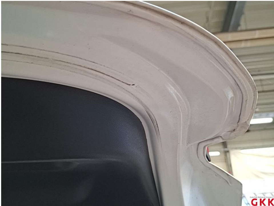
Bild 29 Heckklappe, innen, verkratzt, Spotlackieren
