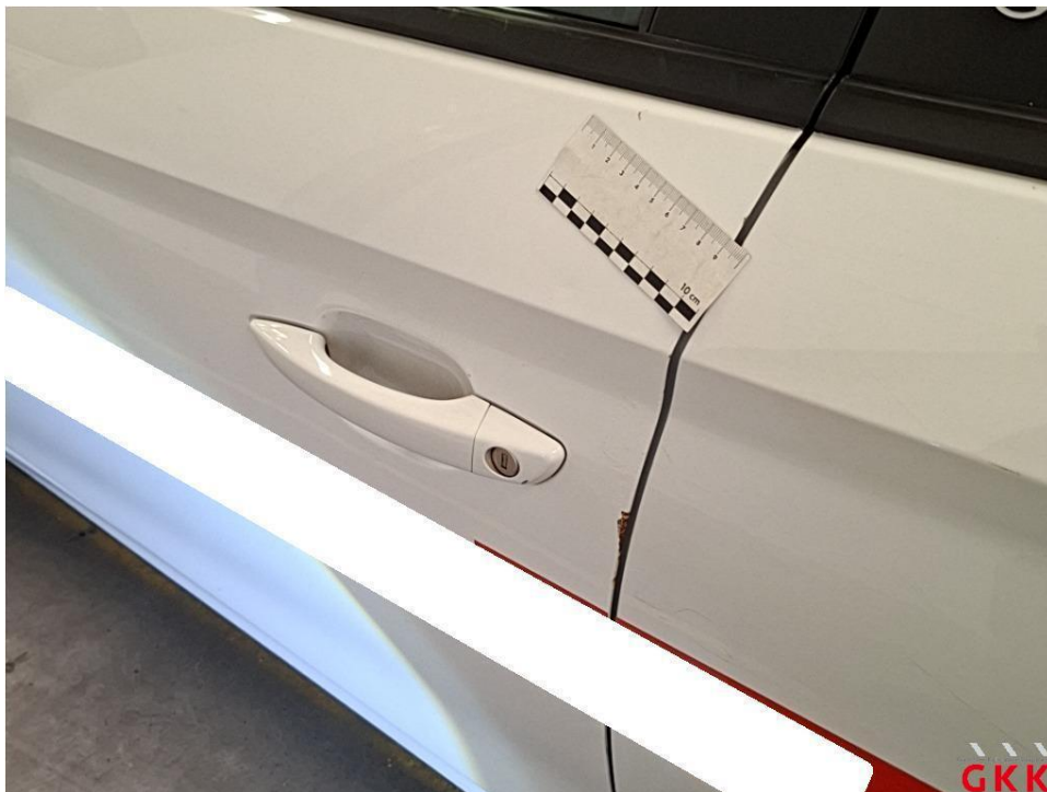
Bild 34 Tür vorne links, Reparaturmangel, instand setzen - lackieren
