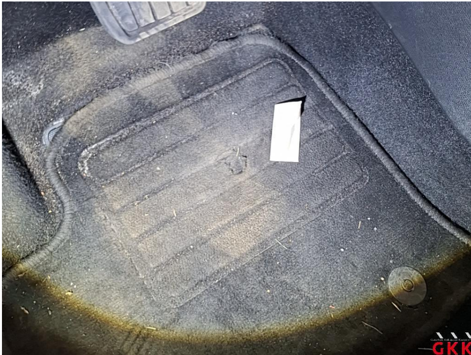
Bild 37 Fußmatte(n), vorne links, beschädigt, ersetzen
