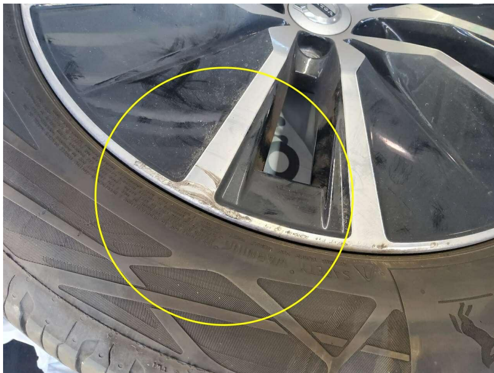
Bild 15 : Felge Sommer hinten links verschrammt Glanzgedreht
