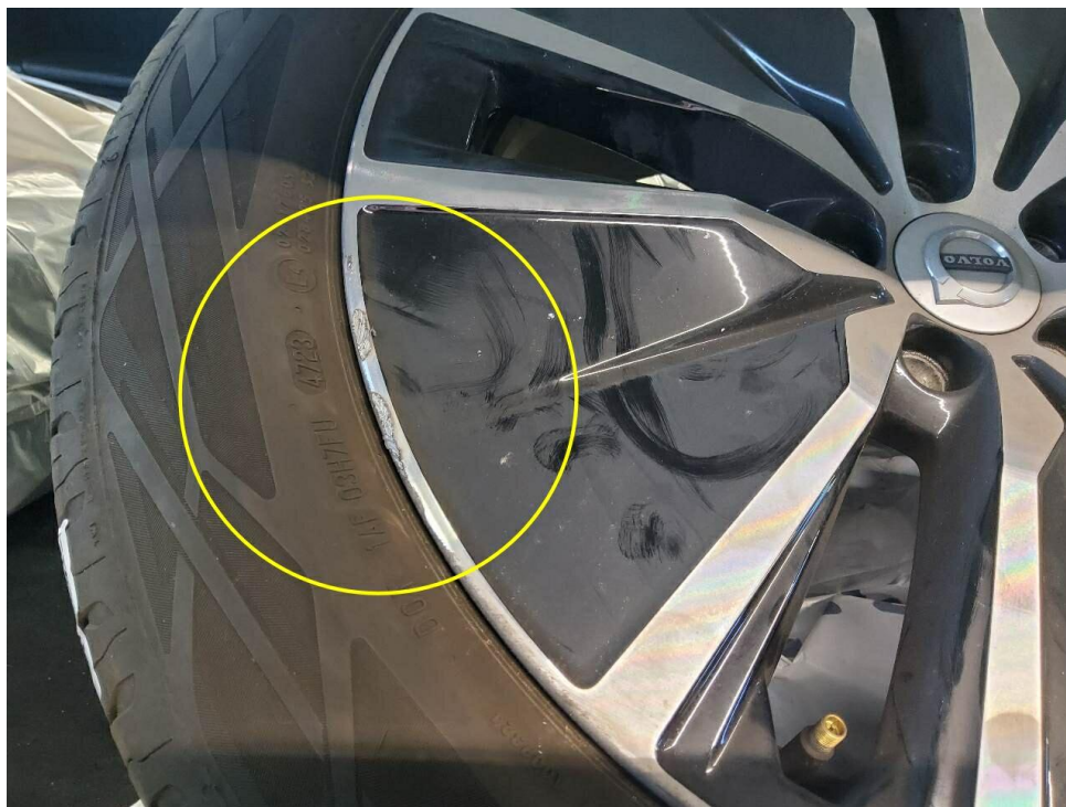
Bild 16 : Felge Sommer vorne rechts verschrammt Glanzgedreht
