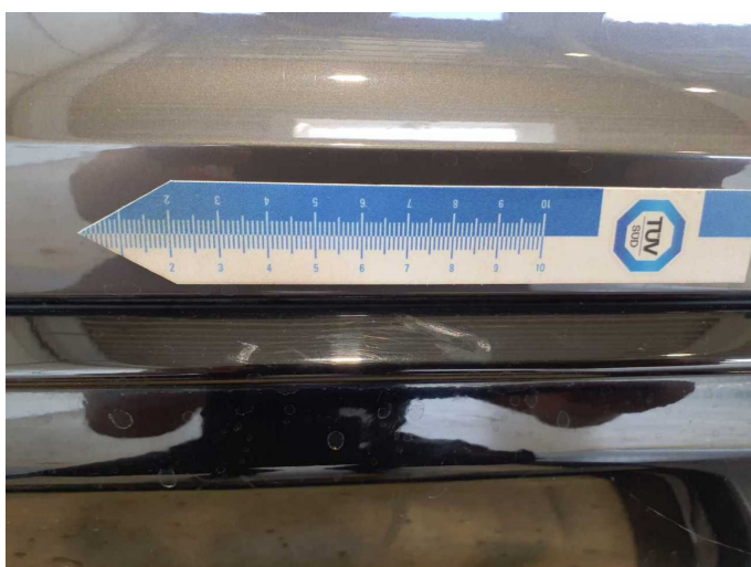
Damage 9: Rear bumper: Rear bumper (Zierleiste) - Scratch(es) - Replace
