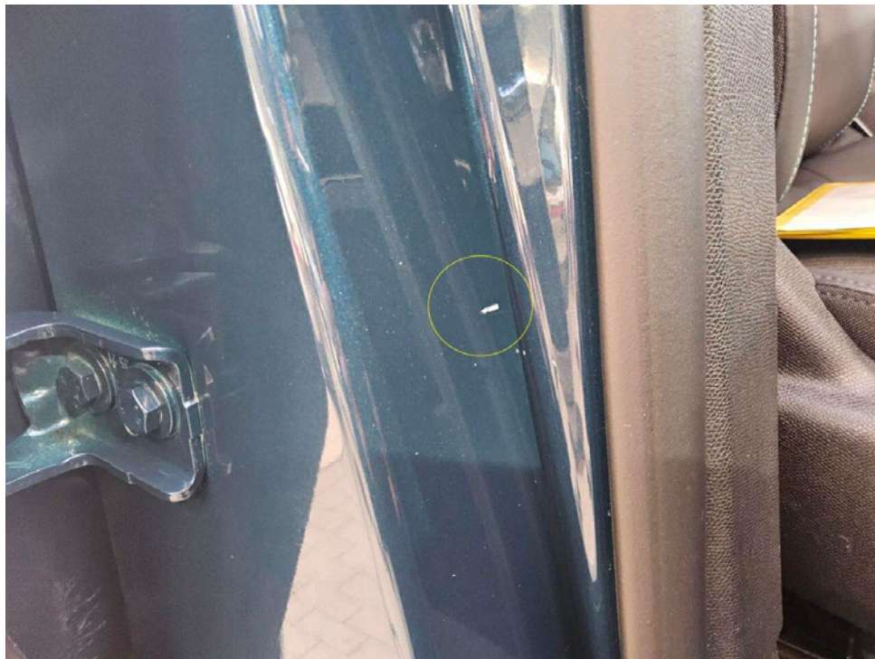
Bild 16 : Tür vorne rechts Einstieg, zerkratzt, smart repair
