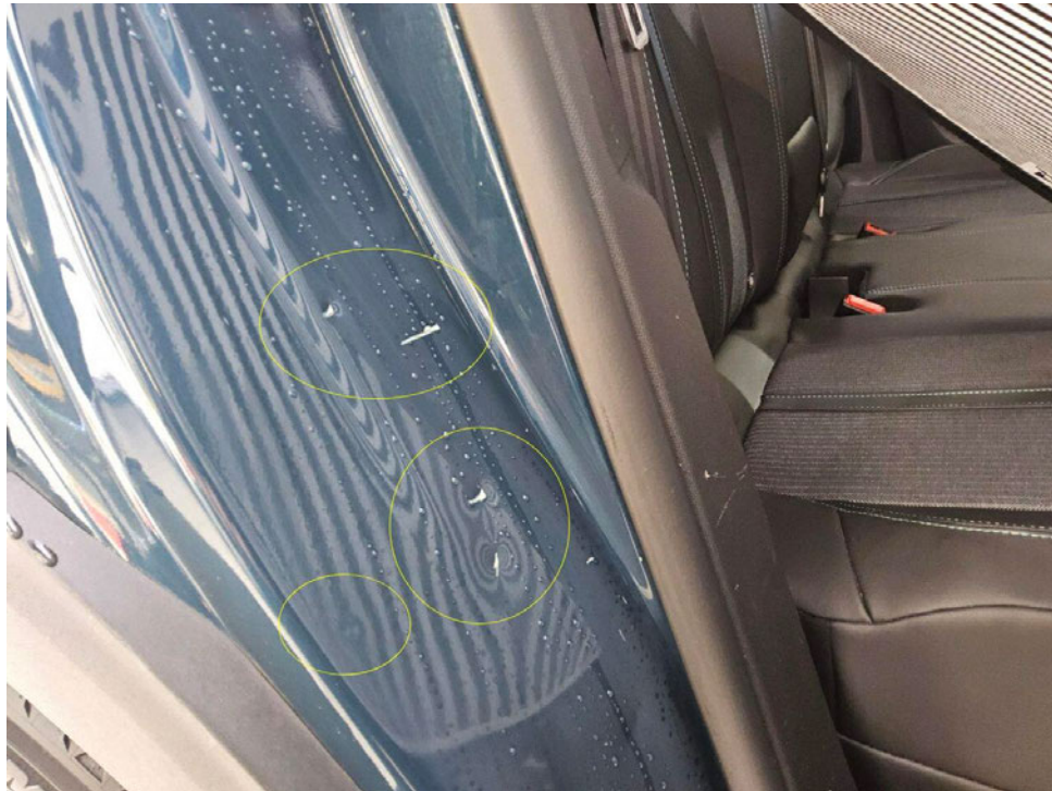
Bild 19 : Tür hinten rechts Einstieg, eingedellt, smart repair
