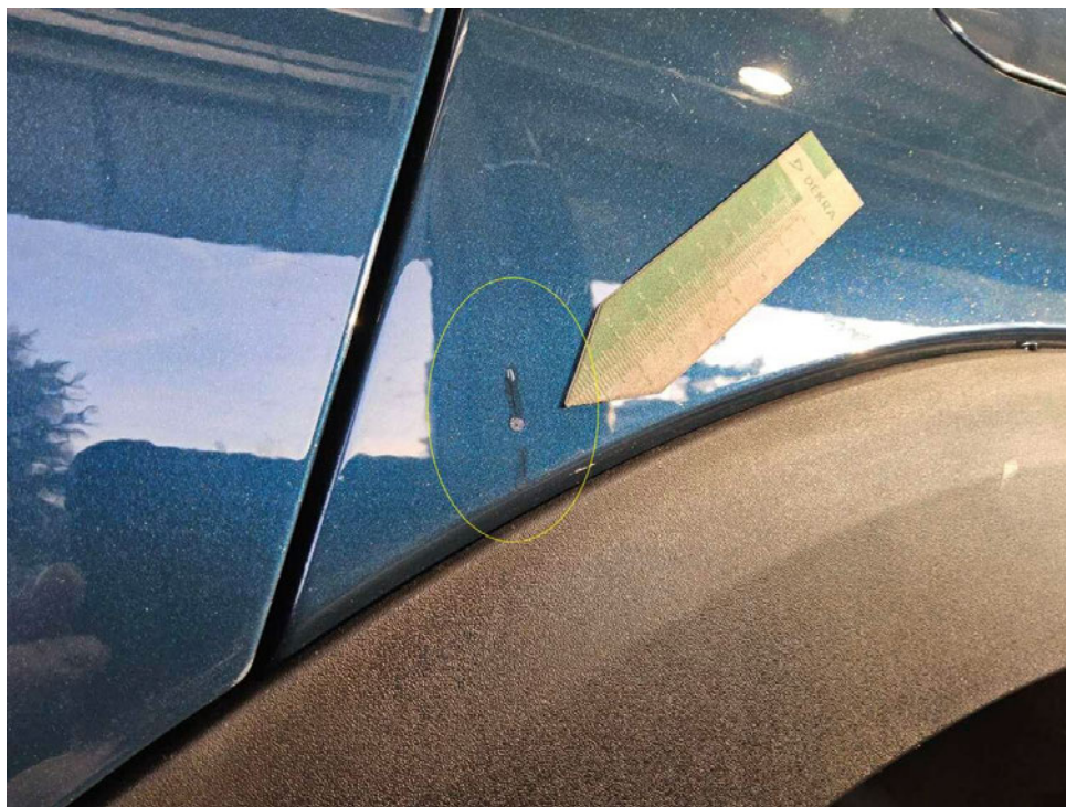
Bild 12 : Seitenteil hinten links Lackierung, zerkratzt, lackieren
