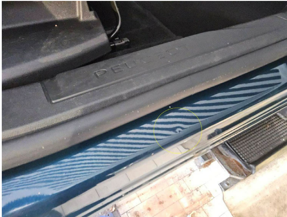
Bild 15 : Tür vorne rechts Einstieg, zerkratzt, smart repair
