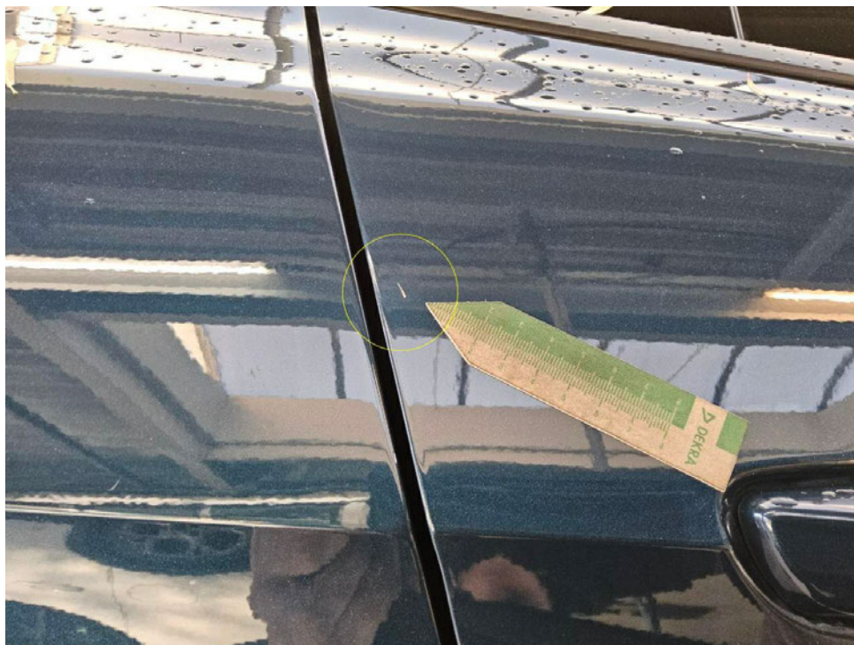
Bild 11 : Tür hinten rechts, eingedellt, instandsetzen und lackieren mit Lackaufbau
