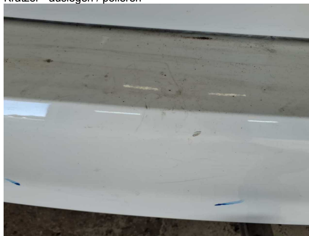
Beschädigung #2: Stossfänger hinten: Stossfänger hinten - Kratzer - auslegen / polieren
