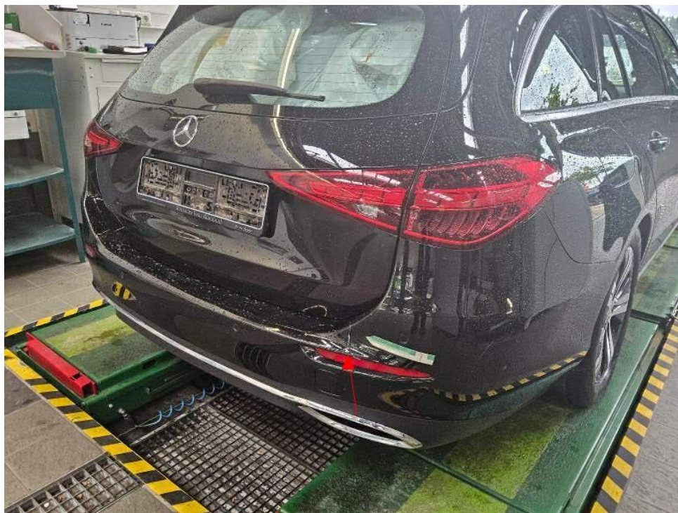
Bild 14 : Stoßfänger hinten gerissen
