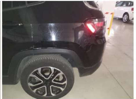
Modanatura parafango / Posteriore Sinistro / Riga
