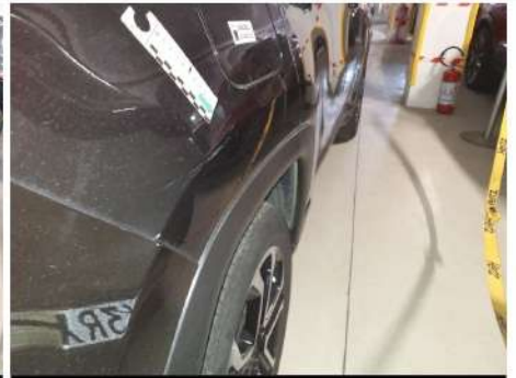
Parafango / Posteriore Destro / Rientranza
