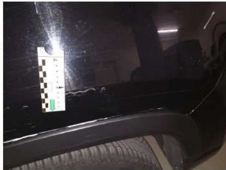
Parafango / Posteriore Sinistro / Rientranza
