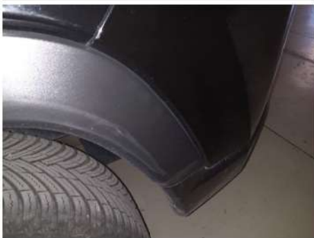
Modanatura parafango / Posteriore Sinistro / Riga
