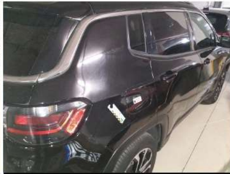
Parafango / Posteriore Destro / Rientranza
