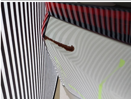
Kotflügel / Hinten Rechts / Delle
