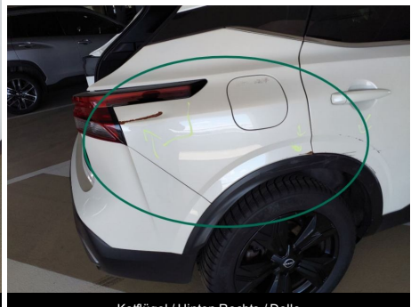
Kotflügel / Hinten Rechts / Delle
