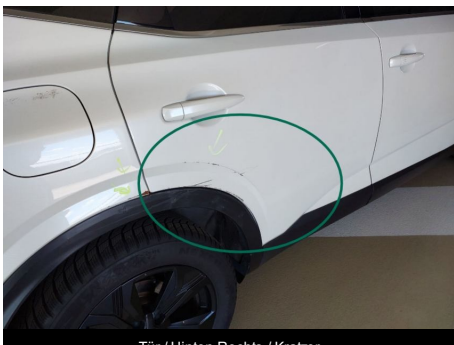
Tür / Hinten Rechts / Kratzer
