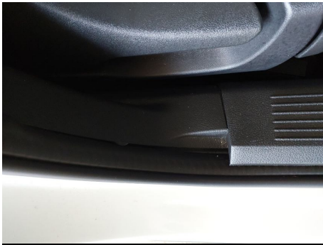
Säulenverkleidung / Rechts / Nicht konform
