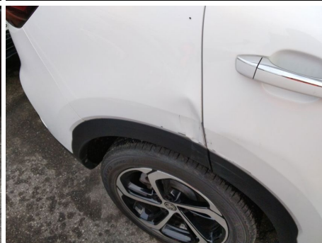
Parafango / Posteriore Destro / Rientranza
