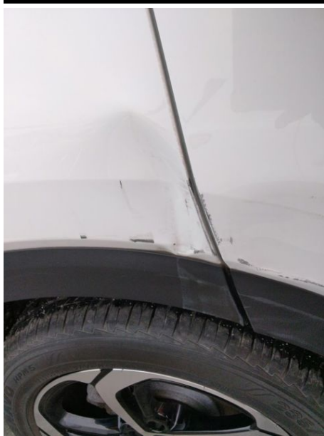
Parafango / Posteriore Destro / Rientranza
