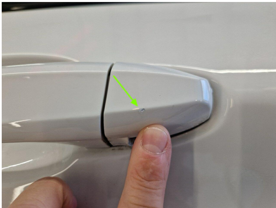
Bild 27 : Türe vorne links, Steinschläge
