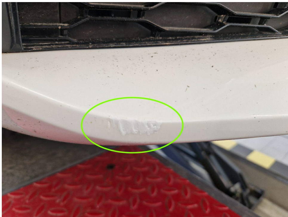
Bild 20 : Stoßstange vorne, verschrammt
