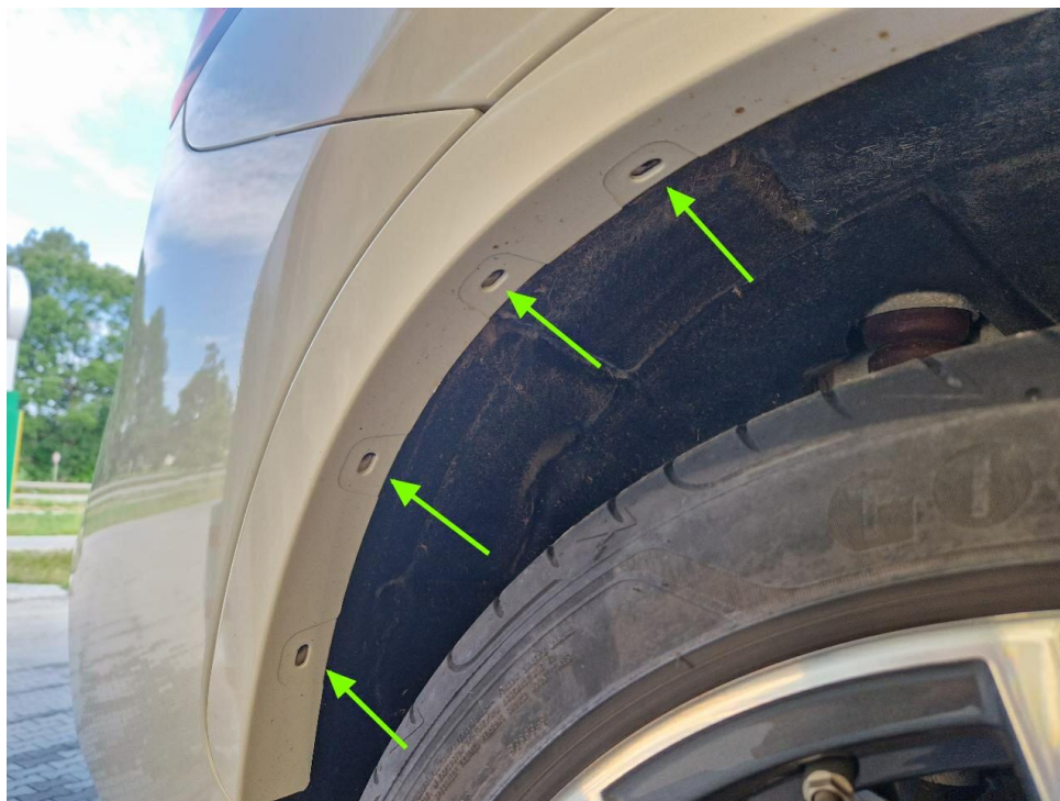
Bild 21 : Radlaufblende hinten rechts, Nieten, fehlen
