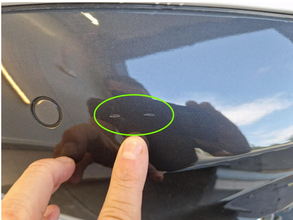
Bild 24 : Stoßstange hinten, Spoiler, mehrfach eingekerbt
