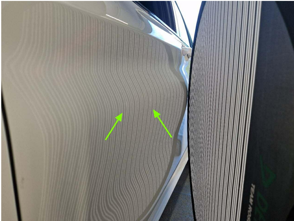
Bild 17 : Türe vorne links, eingedellt
