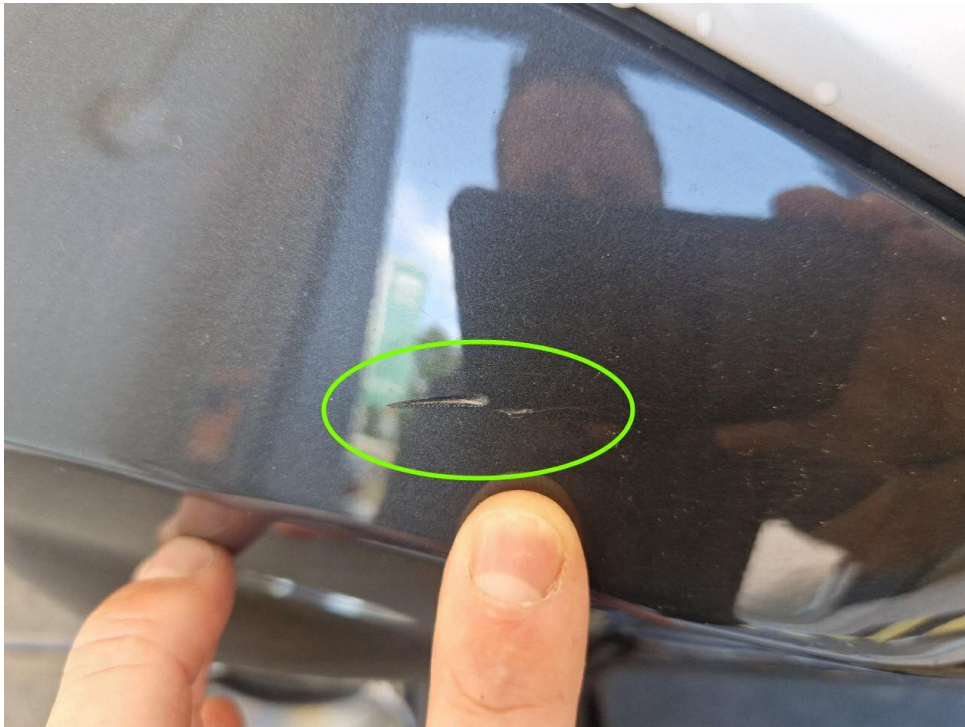
Bild 23 : Stoßstange hinten, Spoiler, mehrfach eingekerbt
