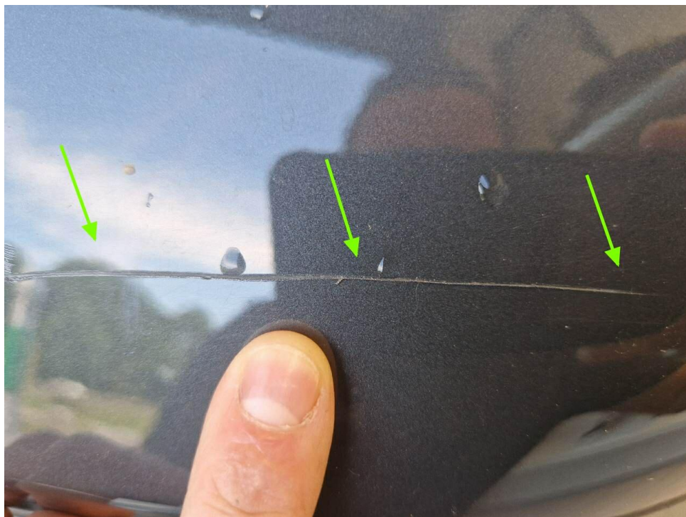
Bild 22 : Stoßstange hinten, Spoiler, mehrfach eingekerbt
