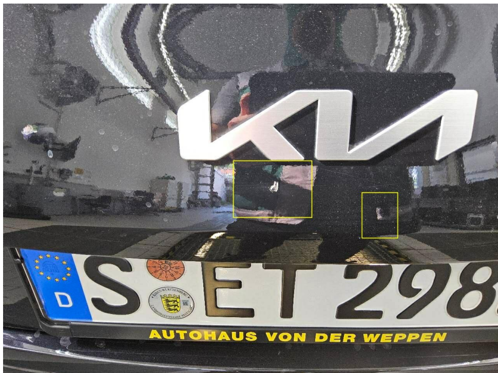
Bild 10 : Heckklappe Blende, zerkratzt
