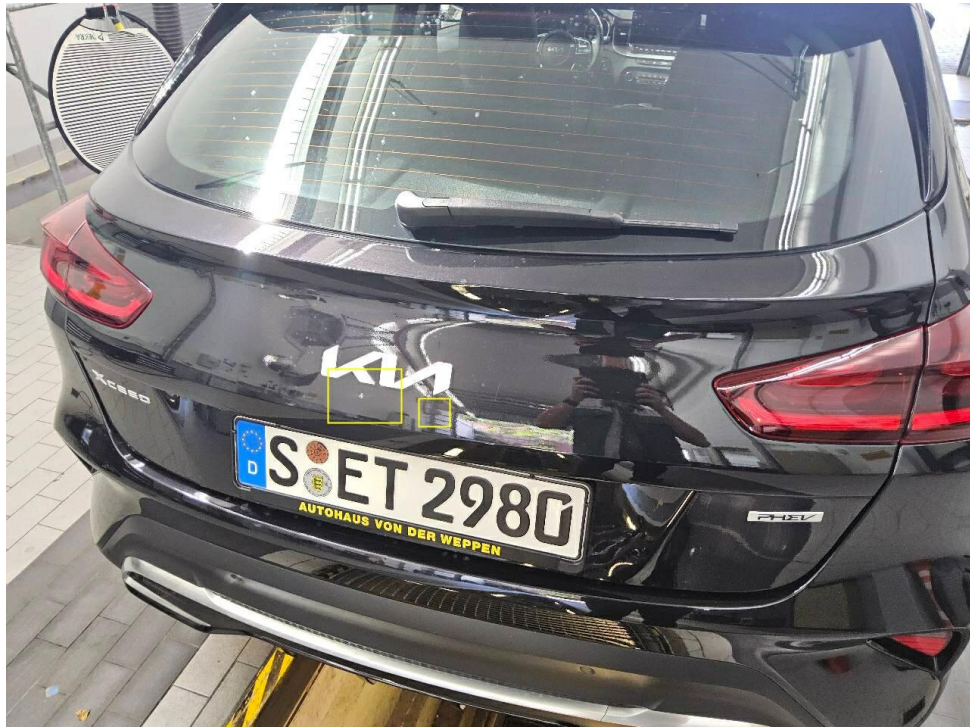
Bild 9 : Heckklappe Blende, zerkratzt
