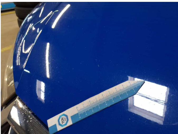
Damage 10: Bonnet: Bonnet (Sandstrahleffekt) - Stone chips - Paint
