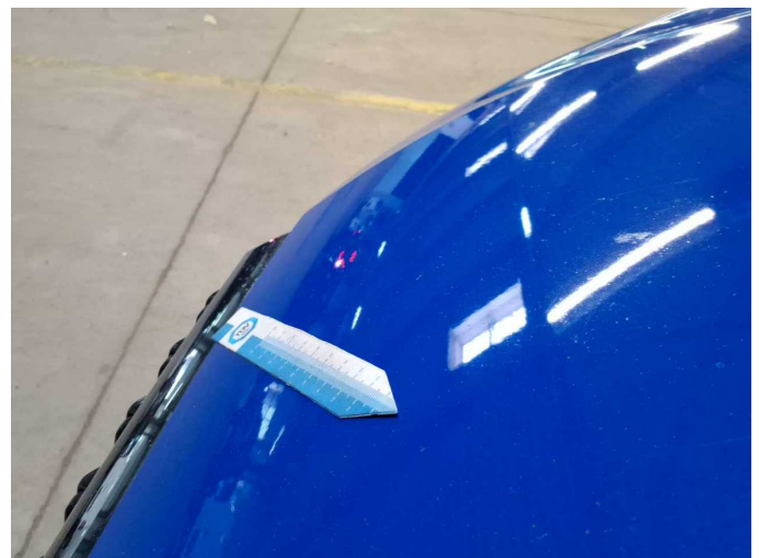
Damage 10: Bonnet: Bonnet (Sandstrahleffekt) - Stone chips - Paint
