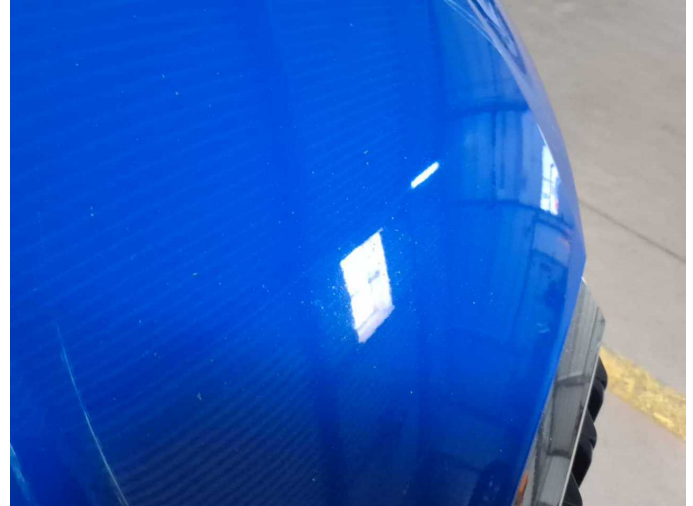
Damage 10: Bonnet: Bonnet (Sandstrahleffekt) - Stone chips - Paint
