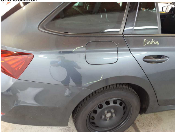
Beschädigung #8: Seitenwand rechts: Seitenwand - verformt - instandsetzen und lackieren
