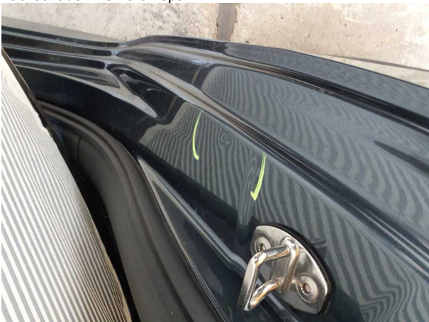
Beschädigung #3: Seitenwand rechts: Einstieg - Delle(n) - Smart Repair
