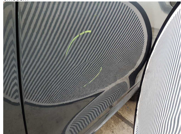
Beschädigung #7: Tür hinten links: Tür - Delle(n) - instandsetzen und lackieren
