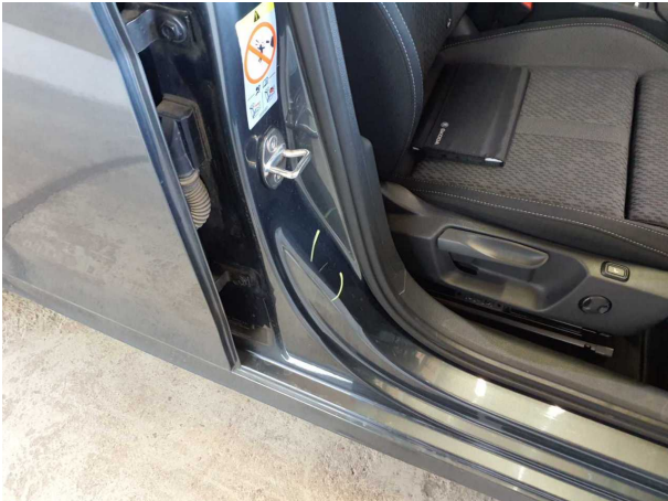
Beschädigung #2: Schweller rechts: Einstieg - Delle / Lackschaden - Smart Repair
