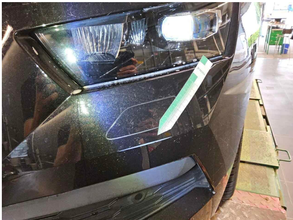
Bild 32 : Stoßfänger vorne Lackierung, zerkratzt, smart repair
