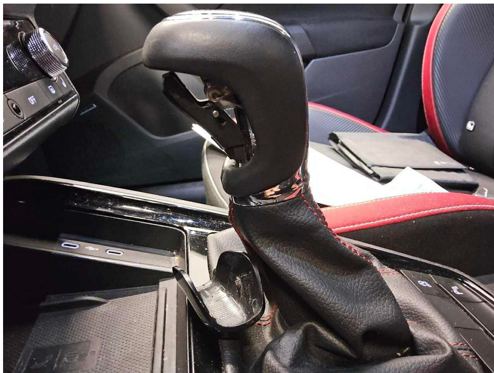
Bild 15 : Schaltknauf, Entriegelungsgriff lose
