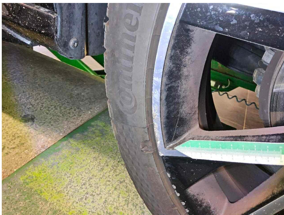
Bild 28 : glanzgedrehte Felge vorne rechts, zerkratzt
