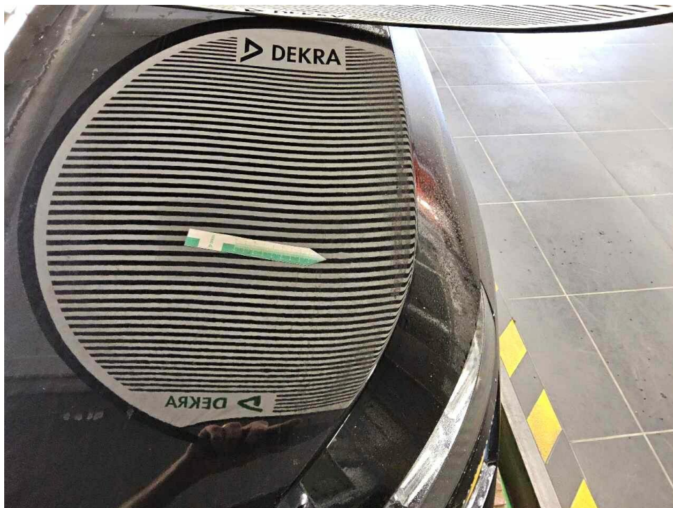
Bild 21 : Motorhaube, eingedellt, Gebrauchsspur
