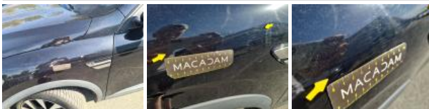
Door FL, Scratch(es), Paint
