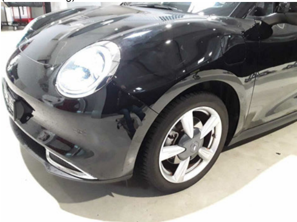
Beschädigung #5: Rad/Reifen: Leichtmetallfelge vorn links (Materialabtrag) - Kratzer - erneuern
