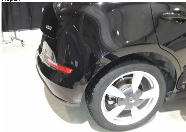
Beschädigung #4: Rad/Reifen: Leichtmetallfelge hinten rechts (Materialabtrag) - verkratzt / verschürft - erneuern
