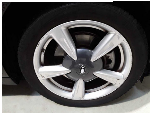
Beschädigung #6: Rad/Reifen: Leichtmetallfelge vorn rechts (Materialabtrag) - verkratzt / verschürft - erneuern
