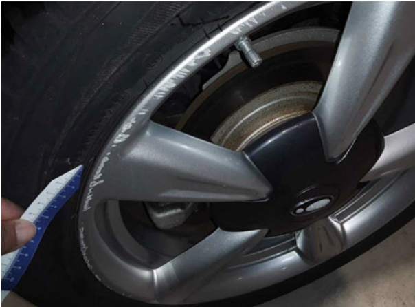
Beschädigung #4: Rad/Reifen: Leichtmetallfelge hinten rechts (Materialabtrag) - verkratzt / verschürft - erneuern
