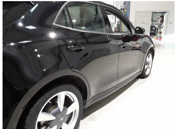
Beschädigung #2: Tür hinten rechts: Tür - Delle(n) - sanft instandsetzen
