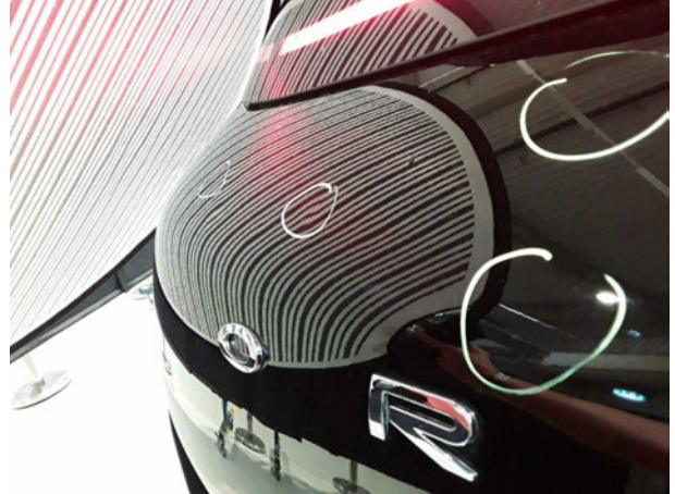
Beschädigung #1: Heckklappe/-tür: Heckklappe - Delle(n) - sanft instandsetzen
