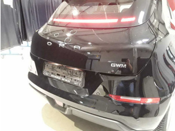
Beschädigung #1: Heckklappe/-tür: Heckklappe - Delle(n) - sanft instandsetzen
