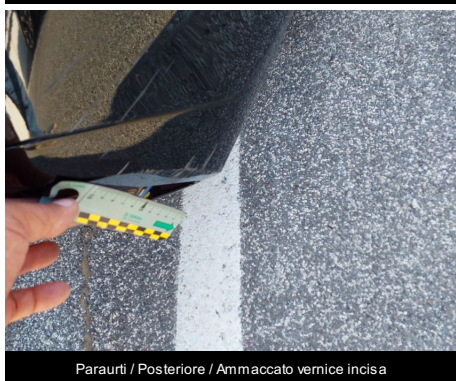
Paraurti / Posteriore / Ammaccato vernice incisa
