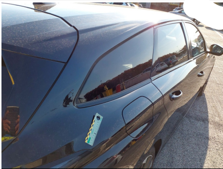
Parafango / Posteriore Destro / Rientranza
