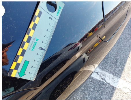
Parafango / Posteriore Destro / Rientranza
