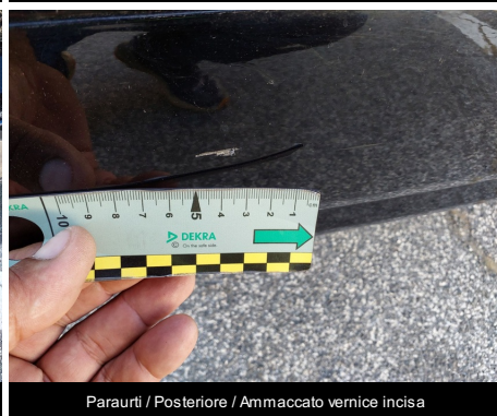
Paraurti / Posteriore / Ammaccato vernice incisa
