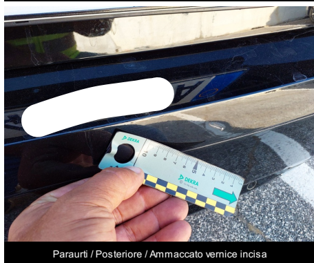
Paraurti / Posteriore / Ammaccato vernice incisa
