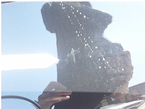
Beschädigung #1: Seitenwand links: Seitenwand - Kratzer - Smart Repair
