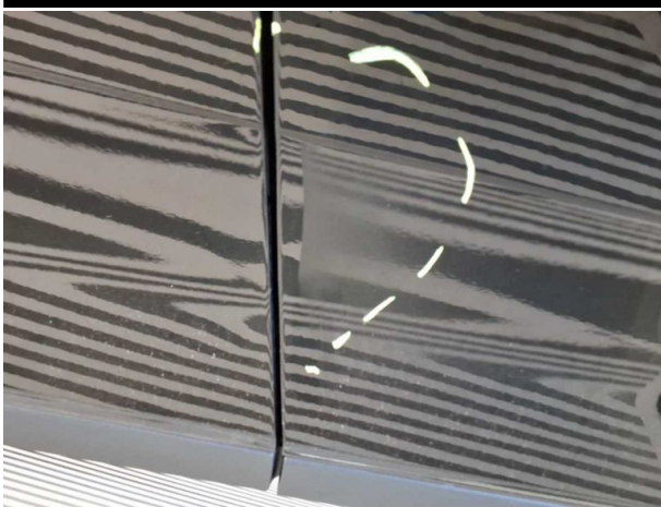
Beschädigung #12: Tür vorn rechts: Tür - verkratzt / verschürft - instandsetzen und lackieren
