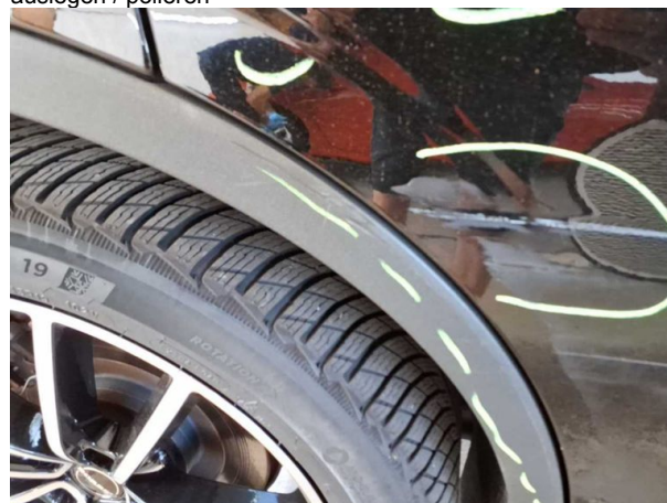
Beschädigung #7: Kotflügel rechts: Radhausverbreiterung - verkratzt / verschürft - erneuern
