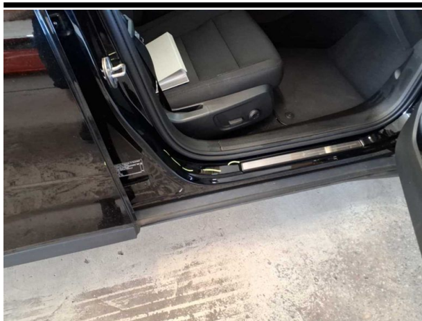
Beschädigung #3: Schweller rechts: Einstieg - Kratzer - auslege... polieren
