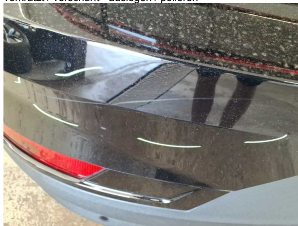
Beschädigung #2: Stossfänger hinten: Stossfänger hinten - verkratzt / verschürft - auslegen / polieren
