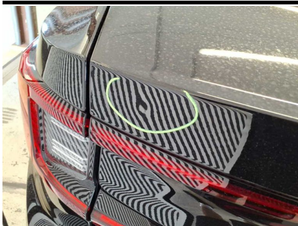
Beschädigung #8: Heckklappe/-tür: Heckklappe - Delle(n) - sanft instandsetzen
