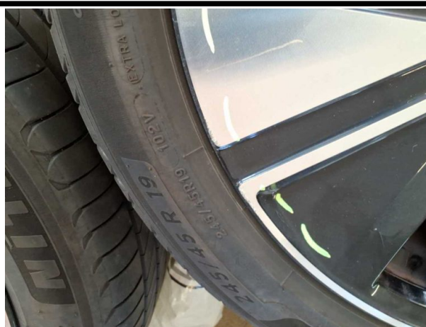
Beschädigung #10: 2.Radsatz: 2 Leichtmetallfelgen - verkratzt / verschürft - Wertminderung
