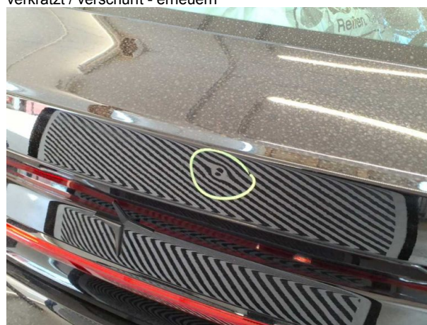
Beschädigung #8: Heckklappe/-tür: Heckklappe - Delle(n) - sanft instandsetzen
