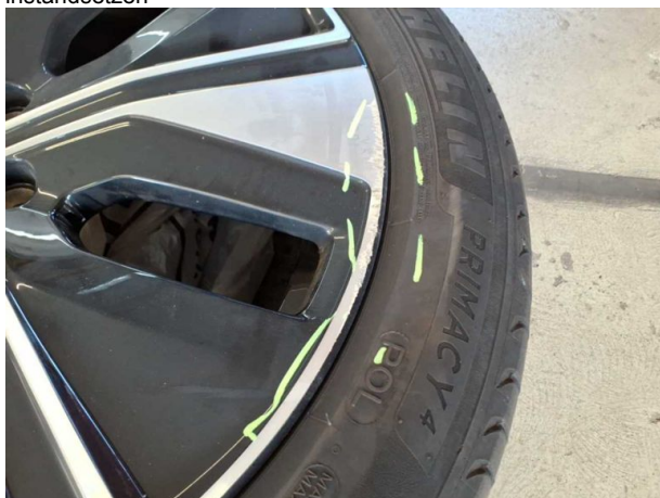
Beschädigung #10: 2.Radsatz: 2 Leichtmetallfelgen - verkratzt / verschürft - Wertminderung
