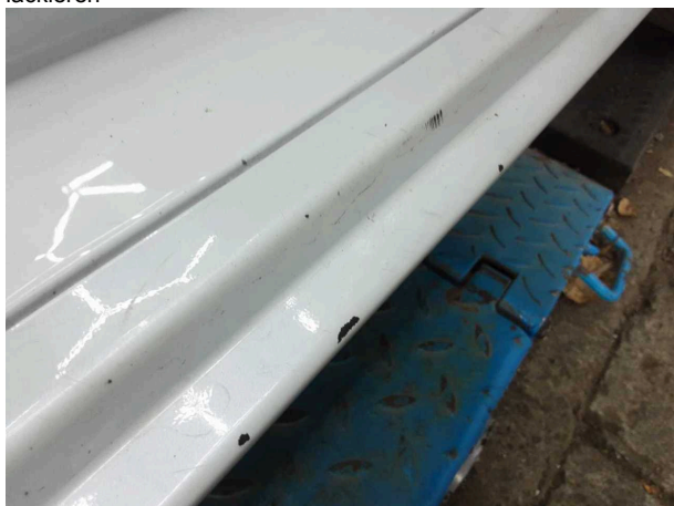
Beschädigung #7: Schweller rechts: Verkleidung - verkratzt / verschürft - lackieren
