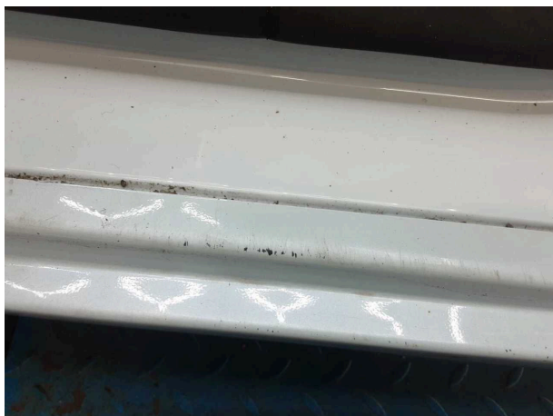
Beschädigung #6: Schweller links: Verkleidung - verkratzt / verschürft... lackieren
