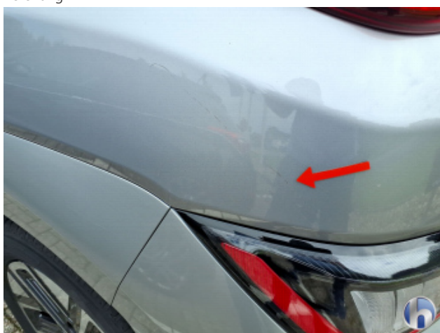
1. Seitenwand - Hinten - Links Oberflächenkratzer - Aufbereiten / Polieren
