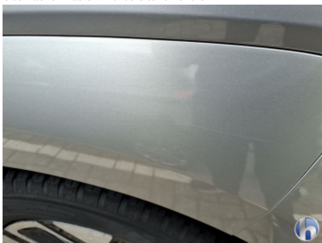
1. Seitenwand - Hinten - Links Oberflächenkratzer - Aufbereiten / Polieren
