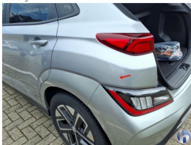
1. Seitenwand - Hinten - Links Oberflächenkratzer - Aufbereiten / Polieren
